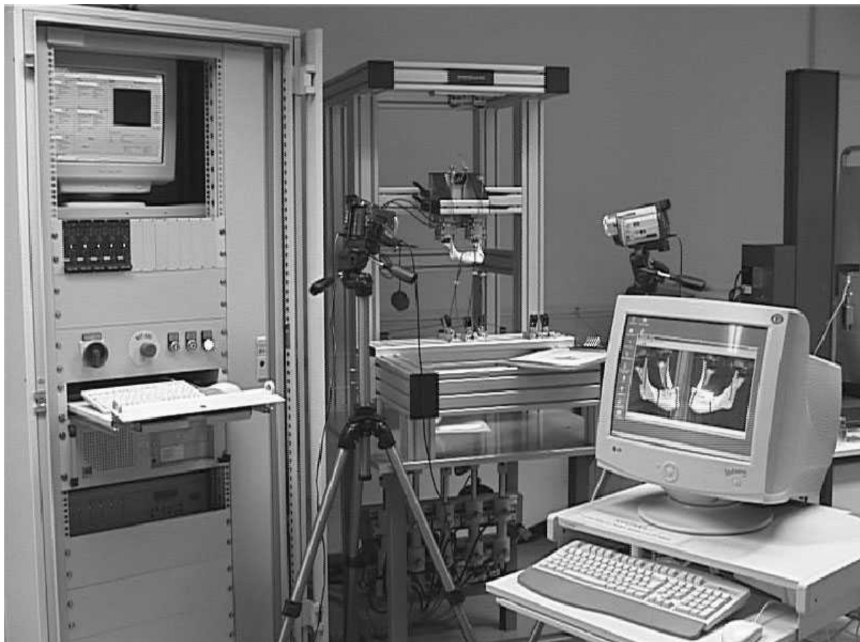
Abbildung 10: biomechanischer Versuchsstand als modulares Gestell
