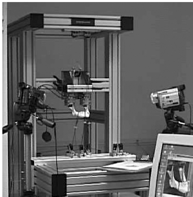
Abbildung 27: Versuchsstand mit Bewegungserfassungssystem
