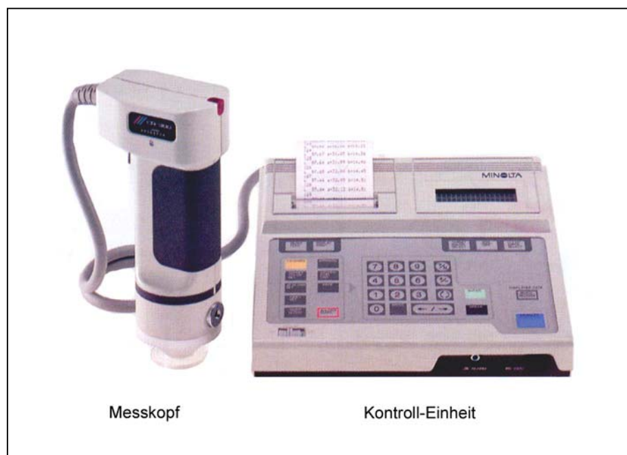
Abb. 2.1: Aufbau des Minolta-Chromameters [29]
