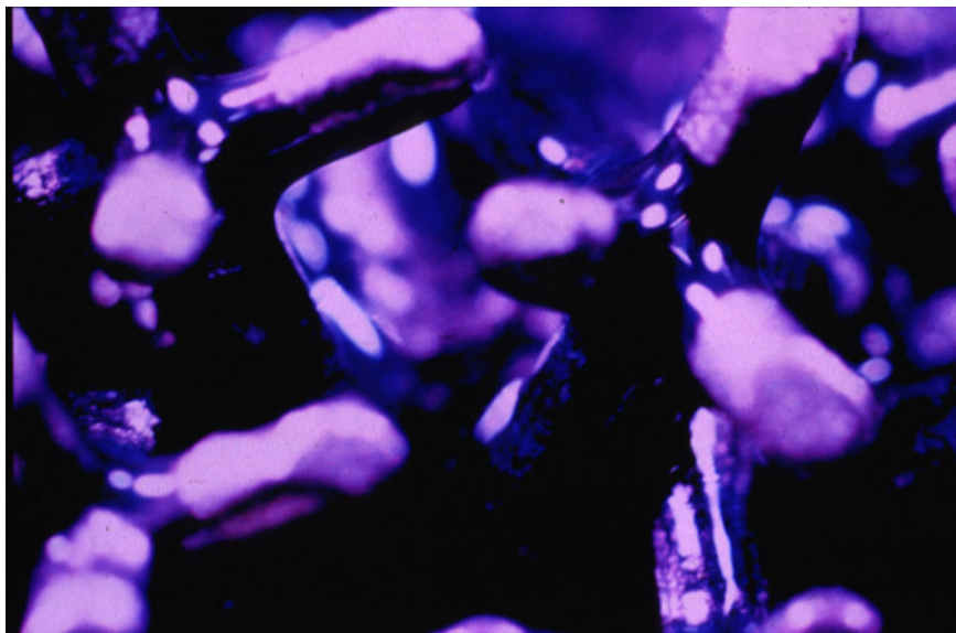
Abbildung 22: Poly-D,L-Laktid-Beschichtung auf Tumorprothese mit interkonnektierender Oberfläche, Lösungsmittel Chloroform
