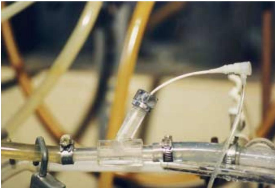
Abb.32: Schleuse zur Einbringung der Ultraschallsonde „Flowwire“ in den Strömungskreislauf
