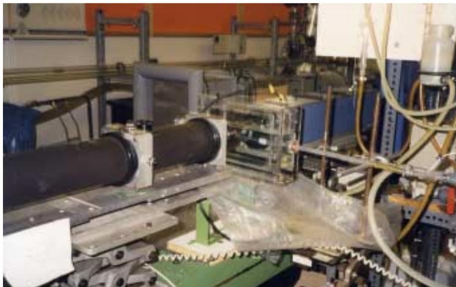
Abb.27: Laser-Doppler-Anemometer (links), Modellkasten (mitte) und Photomultiplier (blau, rechts)
