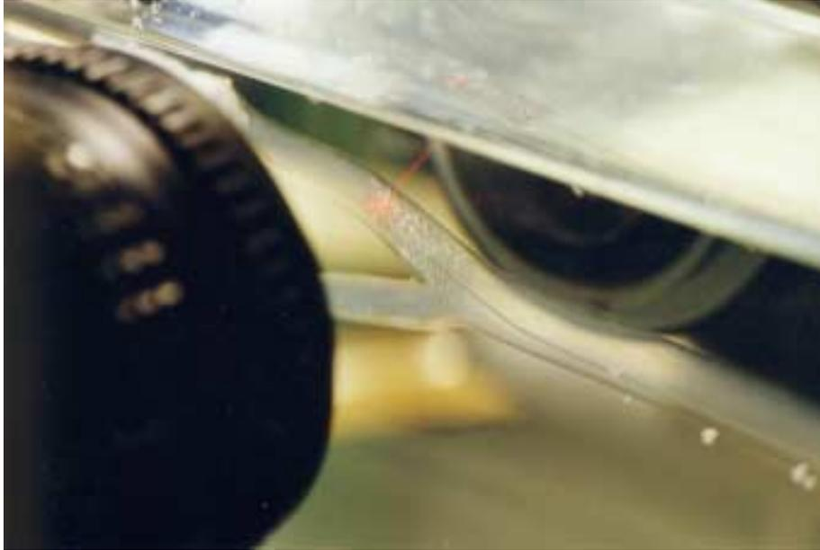
Abb.28: Modell mit Stent IV, Flowwire und Laser. Die beiden Laserstrahlen kreuzen sich in der Mitte des Gefäßlumens.
