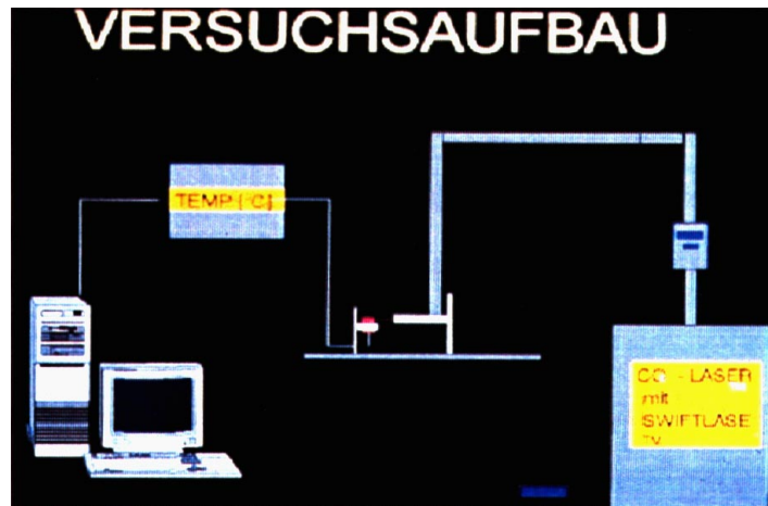
Abb. 23: Versuchsaufbau zur Bestimmung des thermischen Effektes der Laserbestrahlung
