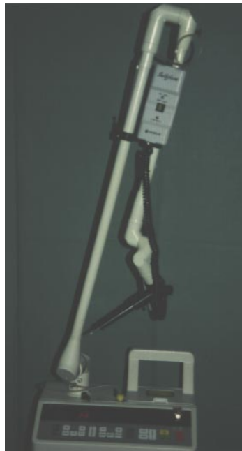
Abb. 15: CO 2 -Laser mit Swiftlase® und Spiegelgelenkarm
