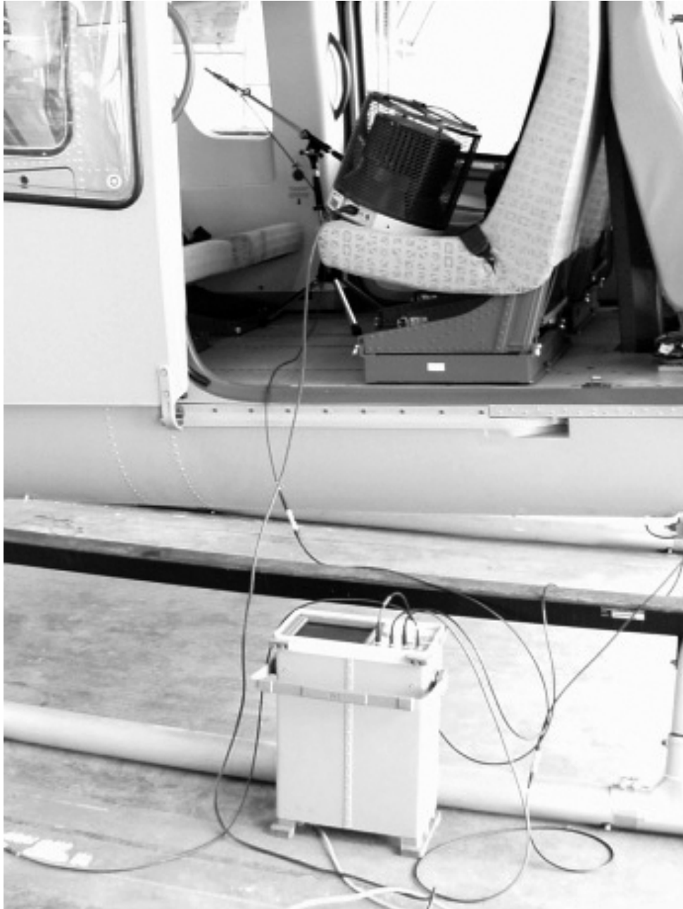
Abbildung A.4: Messaufbau der Absorptionsmessungen mit Normschallquelle in der Hubschrauberkabine
