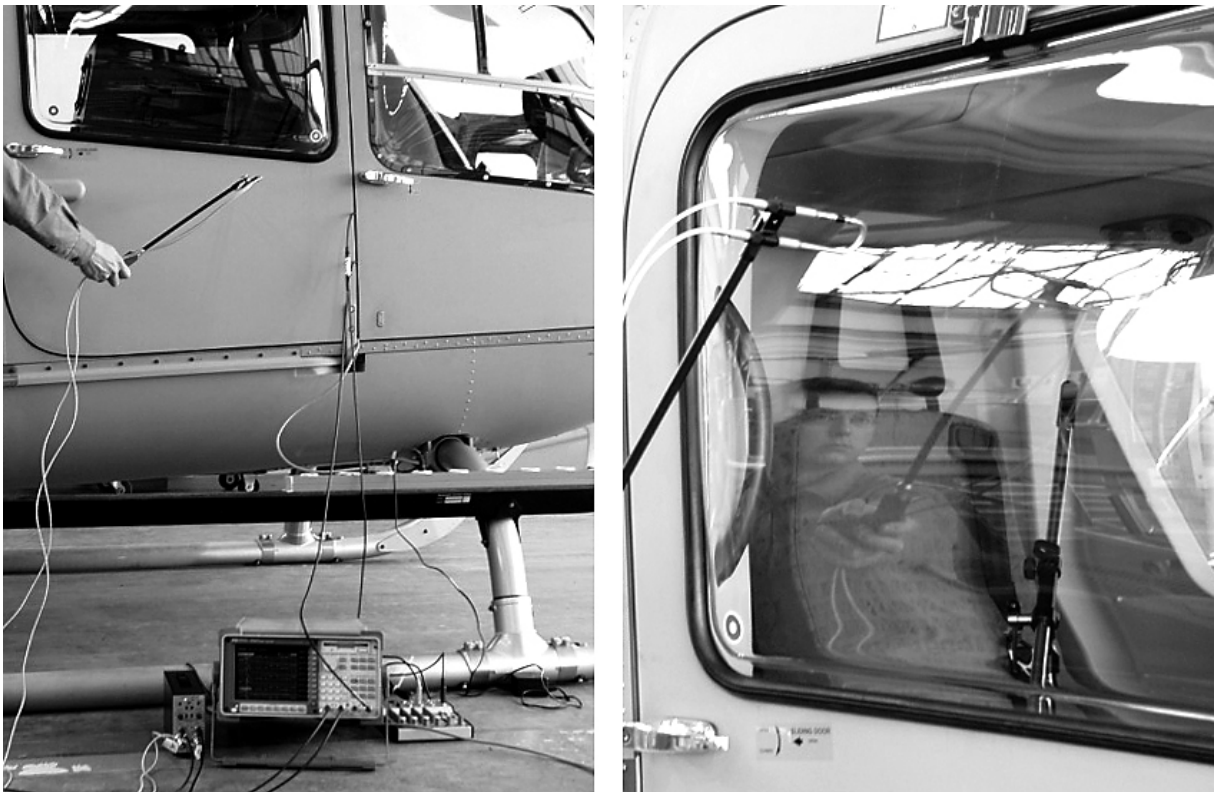
Abbildung 8.1: Messaufbau am Hubschrauber mit Analysator und Detail der Intensitätsmesssonde
