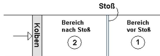
Abbildung 3.23.: Kolbenmodell
