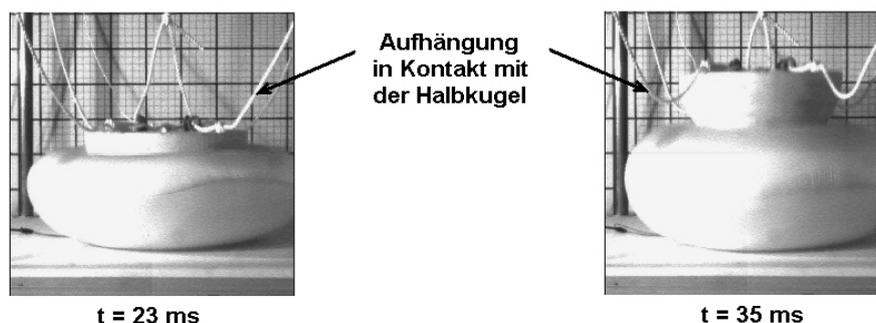
Abbildung 4.4.: Kontakt der Halbkugel mit der Seil-Aufhängung
