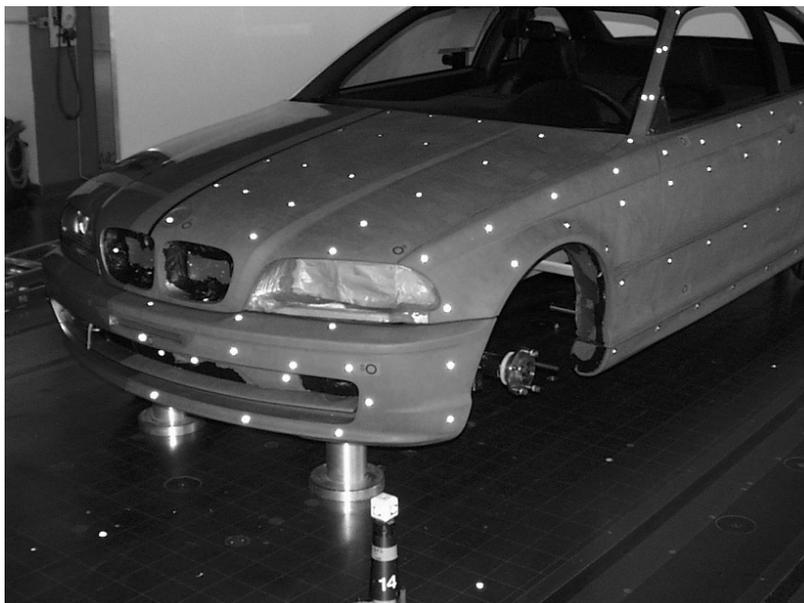
Abbildung 5.5 Photogrammetriemarken auf einer Fahrzeugoberfläche
