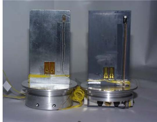
**Abbildung 2.4:** Ansicht der instrumentierten Versuchsbeschaukelung mit DMS und Miniaturdruckaufnehmer.
