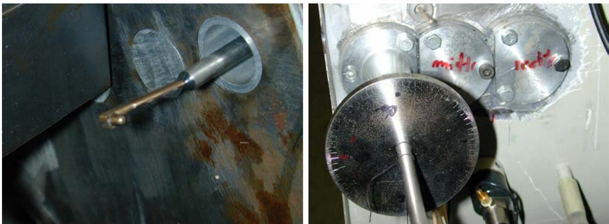
**Abbildung 2.6:** Einbausituation und Haltevorrichtung für die pneumatischen und thermischen Sondenmessungen.
