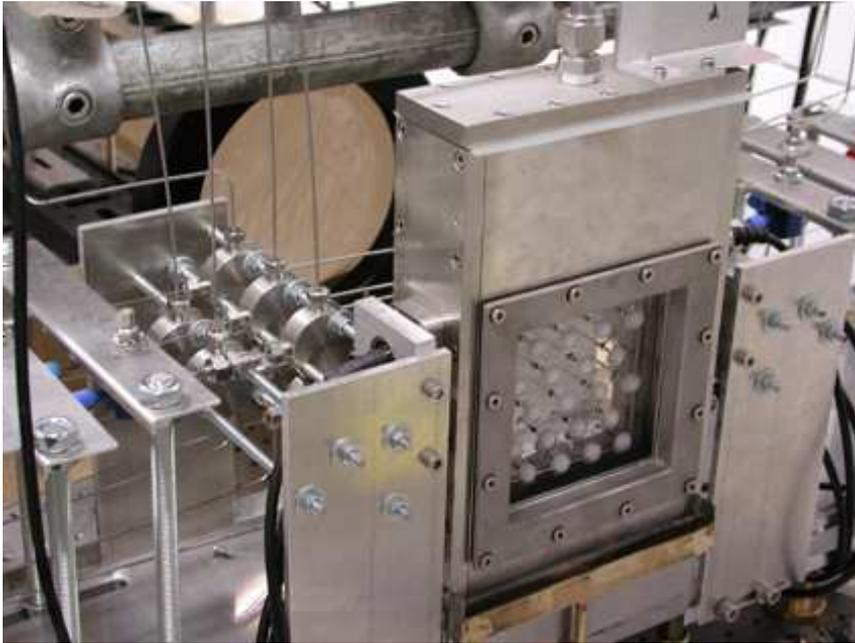
**Abb. 2.5:** Messzelle mit Tropfenschwarm und Peripherie
