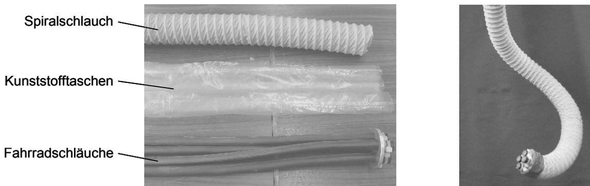
Abbildung 9-1: Funktionsprototyp Ammers. Links: Bauteile, rechts: System in gekrümmter Form.
