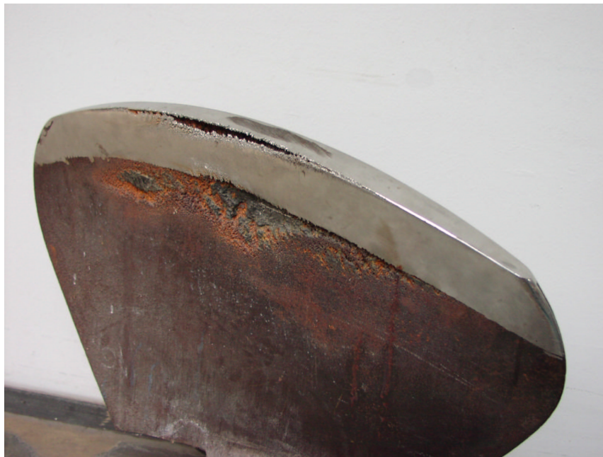
Abbildung 1.3: Kavitationserosion an einer Kaplanturbinenschaufel.
