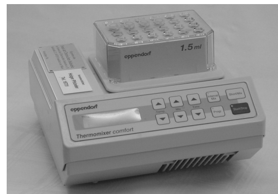
Abbildung 4.7.1: Links: Mikrotiterplattenschüttler mit Deepwell Mikrotiterplatte für parallel durchgeführte Parameterstudien mit 0,5 mL Reaktionsvolumen; während der Inkubation wurde die Mikrotiterplatte luftdicht verschlossen; rechts: Thermomixer zur Bestimmung der Gesamtaktivität
