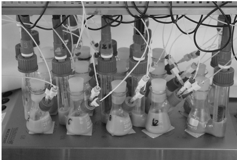
Abbildung 4.8.1: Versuchsanordnung bei Optimierungsversuchen in pH-kontrollierten 20 mL Ansätzen; die Durchmischung erfolgte mit Magnetrührstäbchen auf einem induktiven Mehrfachrührplatz (Variomag Poly, H+P); die pH-Regelung erfolgte über das FedBatch Pro System (DASGIP)
