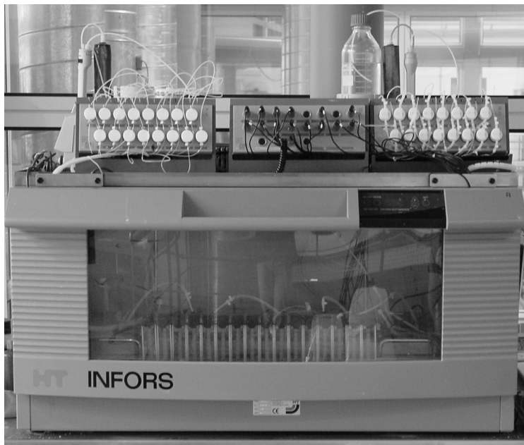
Abbildung 4.7.2: Inkubationsschrank mit Kühl- und Heizfunktion und Mikrodosiersystem DASGIP FedBatch Pro
