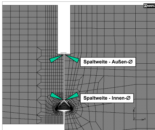
Abbildung 8-2 : Lage der Auswertepunkte für die Spaltweite
