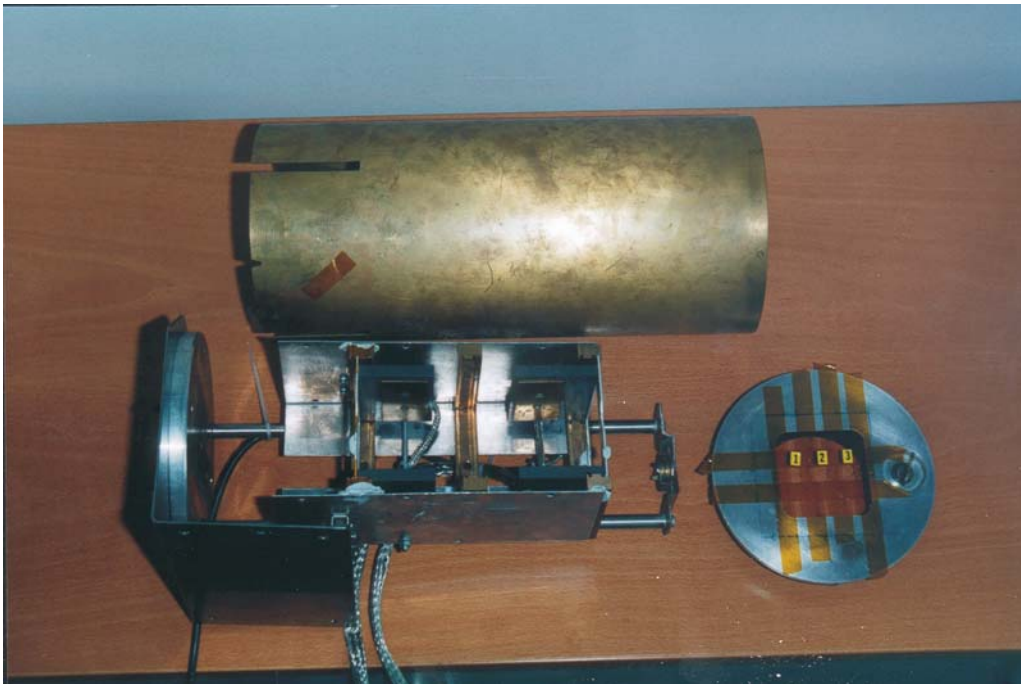
Abb. 7.15: Gruppierete Anordnung des modifizierten Aufbaus nach Reschauer. Links unten ist der eigentliche Aufbau ohne Targethalter zu sehen. Rechts davon liegt eine aus Kaptonband gefertigte Blende, oben ein Messingzylinder zur Abschirmung.
