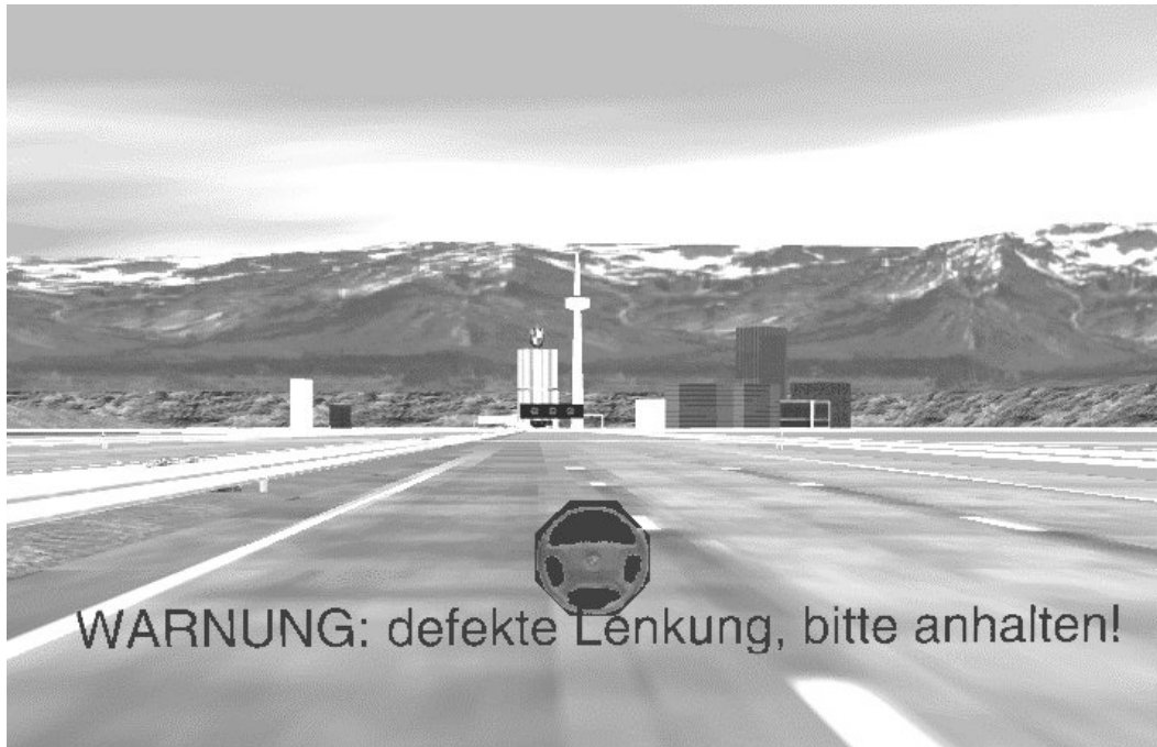
Bild 5-3: Darstellung der optischen Warnung im Fahrsimulator
