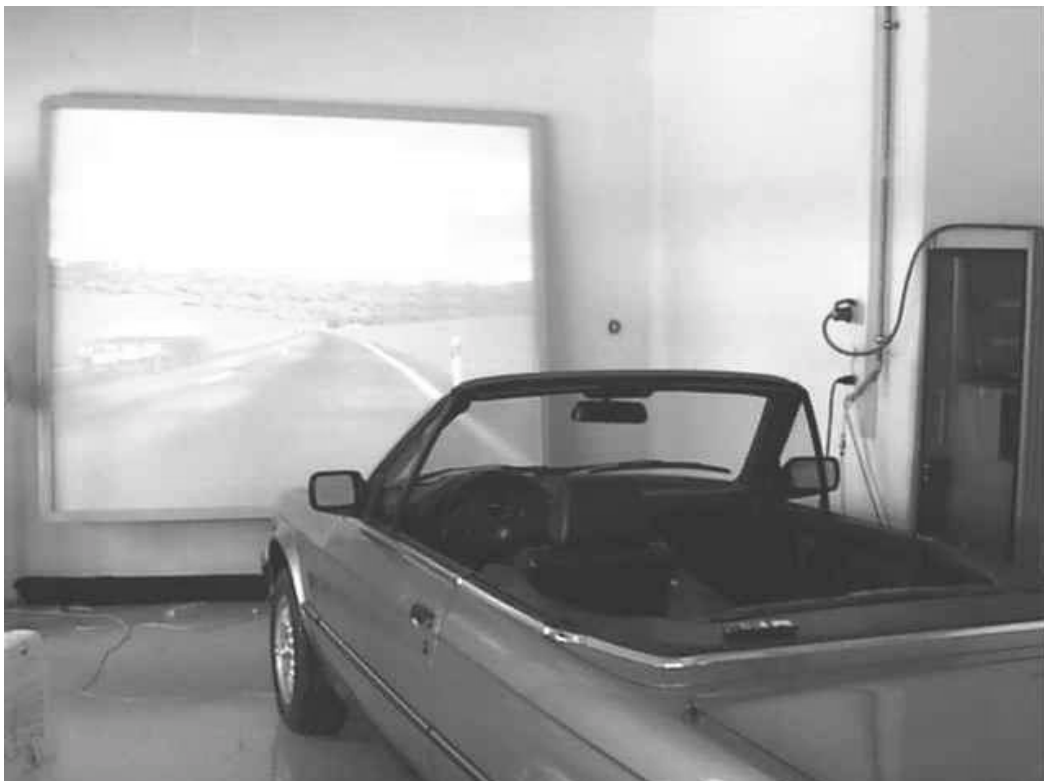
Bild 5-2: Versuchsaufbau des Fahrsimulators des Lehrstuhls für Ergonomie der Technischen Universität München
