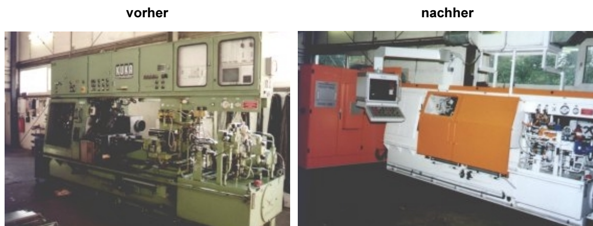
Bild 6.6-2: Überholung und Modernisierung einer Reibschweißmaschine (Fotos: F.K.W. GmbH)
