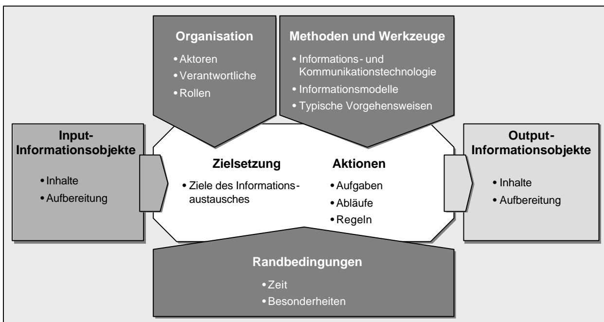
Bild 5.12: Gestaltung des Informationsflusses bei global verteilter Produktentwicklung (Modellierung in Anlehnung an SADT, vgl. [Marca et al., 1988])
