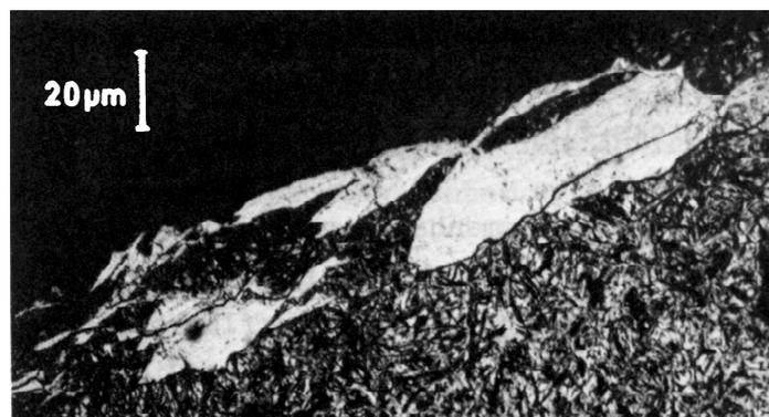
Bild 2.18 White Etching Areas in der Umgebung von Rissen an der Werkstoffoberfläche [48]
