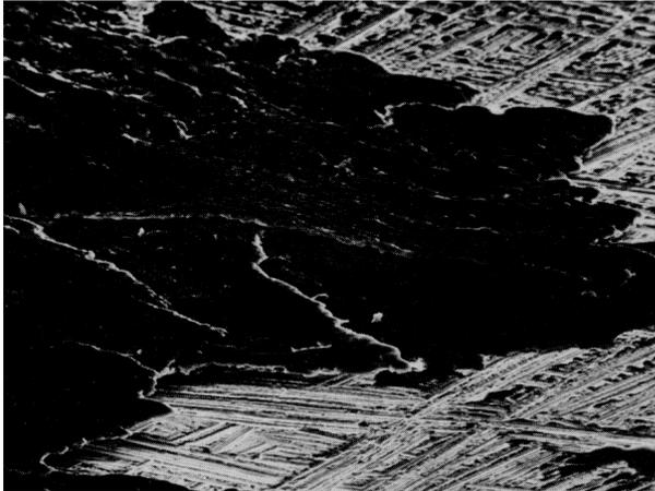
Bild 2.8 Materialübertrag einer Magnesiumlegierung auf Stahl durch Adhäsion (Stahl hell) [30]
