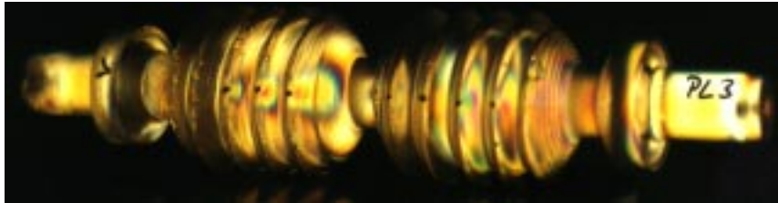
Abb. 7.3: Der zu den Dehnungen proportionale spannungsoptische Effekt ist nur nahe an den markierten Kontaktpunkten erkennbar
