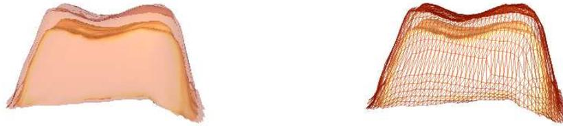
Abbildung 6.3: Generiertes Käppchen in Flächen- (links) und Gitterdarstellung (rechts). Parameter:  $ds_1 = 1.05$  und  $ds_2 = 1.25$  (s. Kap. 6.4.3).
