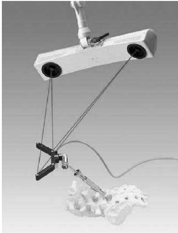
Abbildung 1.3: Ein optischer Tracker verfolgt die Position eines Knochens. Quelle [95]
