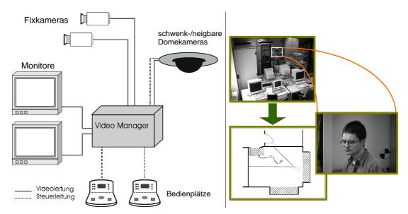
Bild 3.3: Anwendung des Systems in der Sicherheitstechnik zur Überwachung sensibler Bereiche. Links: gängiger Aufbau eines videobasierten Überwachungssystems. Rechts: die eindringende Person wird automatisch detektiert, deren Position dreidimensional vermessen und in einem Grundriss dargestellt. Durch Positionierung schwenk-/neigbarer Domekameras können formatfüllende Aufnahmen erstellt werden.
