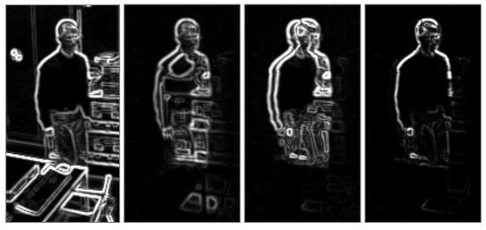
Bild 6.1: Kantenextraktion durch den Sobelfilter. Links: angewendet auf Originalbild. 2. v. links: nach Subtraktion eines Hintergrundbildes. 2. v. rechts: nach Subtraktion zweier aufeinanderfolgender Frames. Rechts: Multiplikation von Sobelfilter angewendet auf Originalbild und Differenzbild zweier aufeinander folgender Frames.
