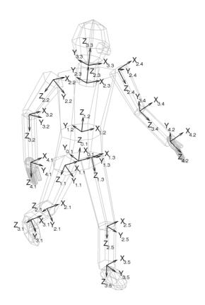
Bild 3.5: **Geometrische Modellstruktur**. Jedem Objektmodellteil ist ein lokales Koordinatensystem zugeordnet, das seine Lage im Raum bestimmt. Die z-Achse wird so gelegt, dass sie mit der Richtung des zugehörigen Knochens zusammenfällt.
