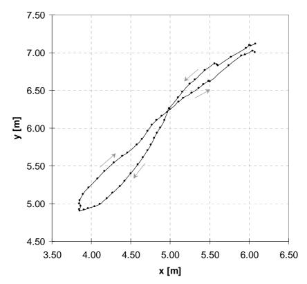
Bild 5.9: **Trajektorie (x- und y-Komponente) der Kopfposition im zweidimensionalen Grundriss bei Stereodetektion**. Durch die Verwendung mehrerer Sichtstrahlen wird eine unabhängige Bestimmung der drei Koordinaten erreicht. Der Verlauf der Trajektorie wird dadurch wesentlich glatter, da Ungenauigkeiten durch Auf- und Abbewegung des Kopfes vermieden werden.
