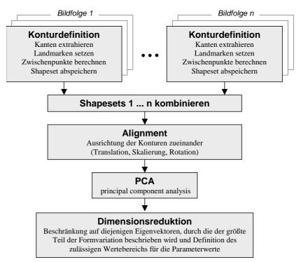
Bild 4.3: Schritte der Modellerstellung.
