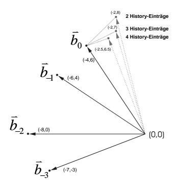
Bild 4.18: Prädiktion des Parametervektors aus den History-Einträgen  $\bar{b}_i$ . Die beiden letzten Vektoren ergeben durch lineare Prädiktion den Vektor (-2,8). Bei Berücksichtigung der Beschleunigung durch zusätzliche Verwendung von  $\bar{b}_{-2}$  wird der Vektor (-2,7) vorhergesagt. Die Verwendung von 4 history-Einträgen führt auf (-2.5,6.5).
