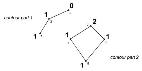
Bild 4.7: **Zweiteilige Kontur**. Durch die Zuweisung der connection types 1101112 (große Indizes) zu den einzelnen Konturpunkten (kleine Indizes) wird ein offener und ein geschlossener Konturteil definiert.
