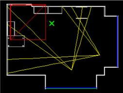
Bild 3.9: Umgebungsmodell. Inventar und Wände werden durch Rhomboide und Kuboide modelliert (links). Im rechten Bild ist die Darstellung in einem zweidimensionalen Grundriss gezeigt. Das Modell erlaubt auch die Definition von Alarmzonen (rot markiert). Gelb eingezeichnet sind die Sichtbereiche der Kameras.
