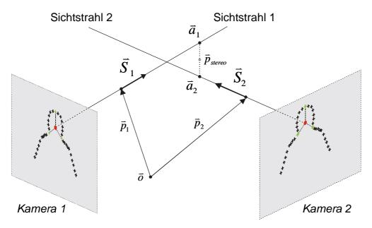
Bild 5.7: **Binokulare Positionsbestimmung** mit n=2 Kameras zur Berechnung des 3D-Schnittpunktes aus den beiden Sichtstrahlen.
