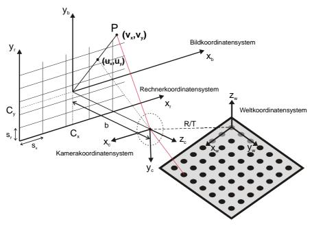
Bild 3.7: Lochkameramodell mit radialer Verzerrung.
