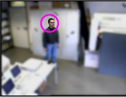
Bild 3.10: Projektion des 3D-Suchraumes für das Objektmodellteil Kopf ins Kamerabild.
