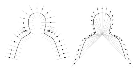
Bild 4.21: **Blowing**. Da bei Subtraktion eines Hintergrundbildes verstärkt Kanten im Inneren einer Silhouette auftreten, können die Startpunkte für die Kantensuche nach außen verschoben werden. Links: Verschiebung senkrecht zum Konturverlauf. Rechts: Verschiebung entlang vom Schwerpunkt ausgehender Vektoren.
