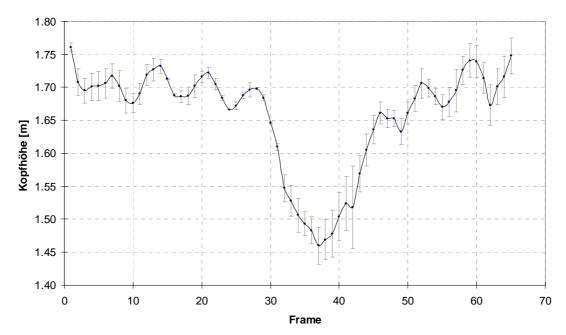
Bild 5.10: **z-Komponente der Kopfposition bei Stereodetektion**. Der im mittleren Bild in Bild 5.8 zu sehenden Abwärtsbewegung des Kopfes ist dessen Auf- und Abbewegen beim Gehen mit der Schrittfrequenz überlagert. Die Fehlerbalken geben den Abstand der Sichtstrahlen bei der Stereo-Zuordnung an.
