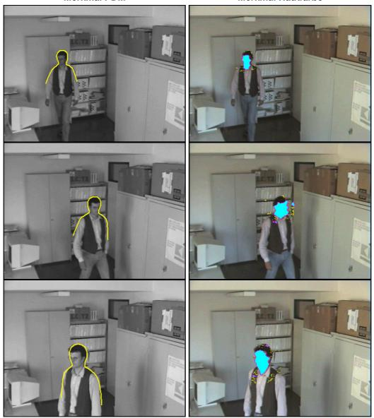
Bild 5.4: Monokulare Detektion. Links: Detektion mit flexiblem Konturmodell (PDM). Rechts: Detektion mit Merkmal "Hautfarbe" (skin). Die gefundene Silhouette bzw. der Bereich, der durch Farbklassifikation als 'hautfarben' klassifiziert wurde, sind farbig markiert.
