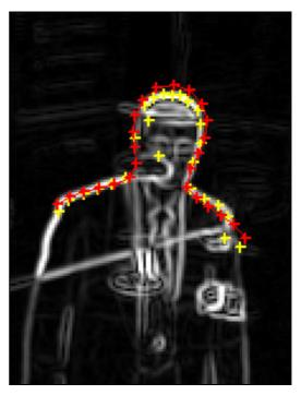
Bild 4.24: **Iterationsschritt bei der Modellsuche**. Die Formparameter der initialen Silhouette (linkes Bild, rot) werden in jedem Iterationsschritt so verändert, dass die im Bild gefundenen Kantenpunkte (gelb) möglichst gut approximiert werden. Die Form der neuen Silhouette (rechtes Bild, rot) ist dabei konsistent mit dem Modell.
