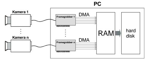
Bild 5.2: Experimenteller Aufbau zur Aufnahme von Sequenzen zur Personendetektion. Die Bilder werden zunächst einzeln oder als ganze Sequenz über direct memory access (DMA) in den Hauptspeicher transferiert und können anschließend unmittelbar ausgewertet oder gegebenenfalls gespeichert werden.
