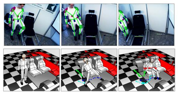
Bild 3.2: Anwendung von STABIL++ in der Ergonomie zur Vermessung des Einstiegsvorgangs in ein Auto. Oben: Simultane Aufnahme der Szene mit drei Kameras mit eingezeichneter Modellhypothese (grün). Unten: dreidimensionale Visualisierung des Trajektorienverlaufes für Füße und Hände.
