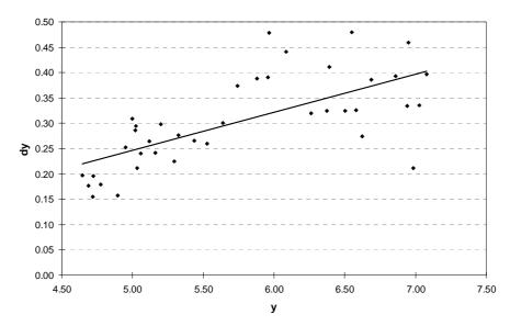
Bild 5.6: **Positionsdifferenz in y-Richtung zwischen Detektion mit Merkmal PDM und Merkmal Farbe**. Ungenauigkeiten im Translationsvektor wirken sich mit zunehmender Entfernung und damit kleinerem Winkel  $\varphi$  stärker aus.
