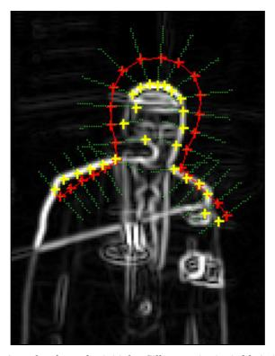
Bild 4.23: Kantensuche. Ausgehend von der initialen Silhouette (rot) wird bei einem Iterationsschritt für jeden Konturpunkt entlang der Senkrechten zum Konturverlauf (grün) nach Kanten im Bild gesucht; die gefundenen Kantenpunkte sind gelb dargestellt.
