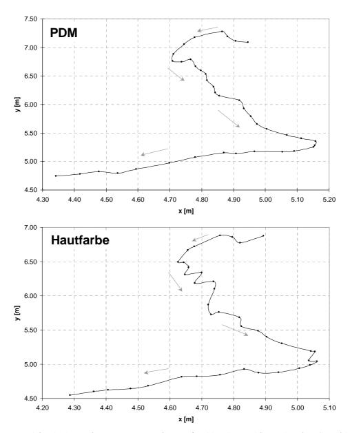
Bild 5.5: Trajektorie (x- und y-Komponente) der Kopfposition im zweidimensionalen Grundriss bei monokularer Detektion. Oben: Auswertung mit Merkmal PDM. Unten: Auswertung mit Merkmal Hautfarbe.
