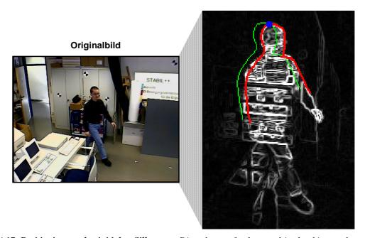
Bild 4.17: Positionierung der initialen Silhouette. Die zuletzt gefundene und in den history shapes gespeicherte Silhouette (grün) wird entsprechend der geschätzten neuen Position des Kopfes (blau markiert) verschoben und in der Größe angepasst. Im Bild ist auch das verstärkte Auftreten von Kanten im Inneren der Kontur zu sehen, da eine Hintergrundschätzung verwendet wird und sich die Person vor stark strukturiertem Hintergrund bewegt.
