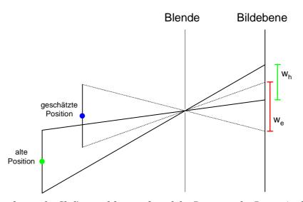
Bild 4.16: Berechnung des Skalierungsfaktors aufgrund der Bewegung der Person (scale from motion). An der alten und neuen (geschätzten) Position für ein Objektmodellteil wird eine Kugel (hier nur eindimensional dargestellt) ins Bild projiziert. Der Skalierungsfaktor, der sich aufgrund der Bewegung der Person ergibt, beträgt w<sub>e</sub>/w<sub>h</sub>.
