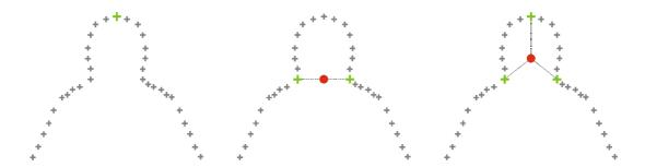
Bild 5.1: Referenzpunkte für den 3D-Übergang. Zur Berechnung des Sichtstrahles können ein oder mehrere 2D Referenzpunkte (grün) verwendet werden. Bei mehr als einem Referenzpunkt wird zunächst der Schwerpunkt im Bild bestimmt (rot). Aus dem so erhaltenen Punkt wird der Sichtstrahl für die jeweilige Kamera ermittelt.
