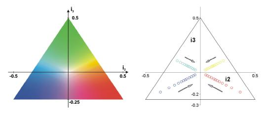
Bild 3.11: **Der i<sub>2</sub>i<sub>3</sub>-Farbraum**. Links: Lage der Farben im i<sub>2</sub>i<sub>3</sub>-Farbraum. Rechts: schematische Darstellung der Verschiebung der Farbklassen in Richtung des Nullpunktes beim Öffnen der Blende.
