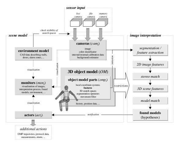
Bild 3.1: Übersicht über das System STABIL++ zur dreidimensionalen Detektion und Verfolgung von Objekten in Videobildfolgen.
