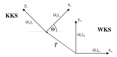
Bild A.1: Transformation zwischen Kamerakoordinatensystem (KKS) und Weltkoordinatensystem (WKS).
