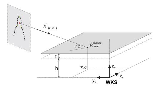
Bild 5.3: Monokulare Positionsbestimmung. Der Sichtstrahl, der von der Position des extrahierten Merkmals im Bild ausgeht, liefert beim Schnitt mit einer Ebene in Höhe des Objektmodellteils den Ursprung des Merkmals (feature center). Dieser Punkt muss noch um die Translation t korrigiert werden, um so auf den Ursprung des lokalen Koordinatensystems des Objektmodellteils zu kommen.
