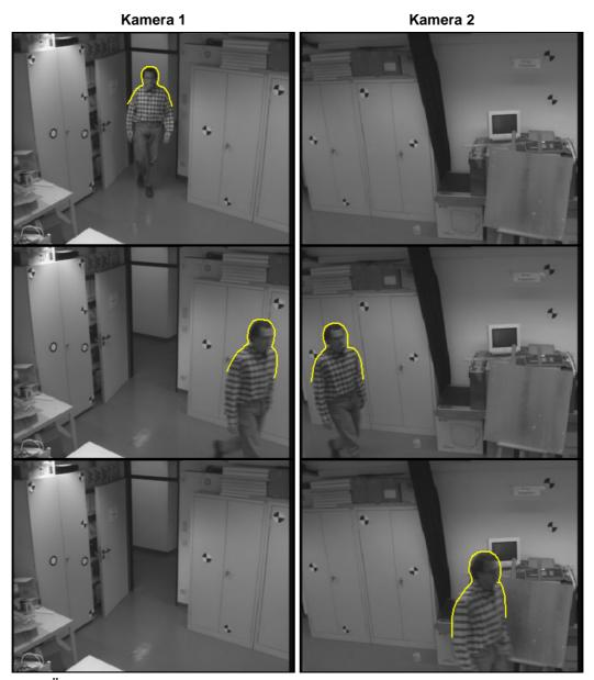
Bild 5.11: Übergabe zwischen zwei Kameras mit Merkmal PDM. Oben: Mono-Schätzung im linken Bild. Mitte: binokulare Positionsbestimmung im gemeinsamen Sichtbereich der beiden Kameras. Unten: monokulare Schätzung im rechten Bild.
