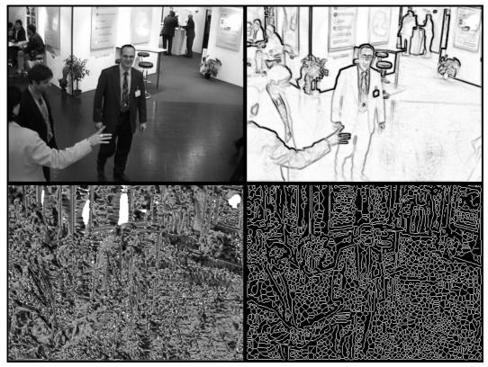
Bild 4.5: Bilder für die Berechnung der Kostenfunktion  $c_{local}(p,q)$ . Oben links: Originalbild. Oben rechts: Amplitude des Sobelfilters  $(c_{mag})$ . Unten links: Richtungskosten beim Übergang zum Pixel links oben  $(c_{dir})$ . Unten rechts: Nulldurchgänge des Laplace-Operators  $(c_{ZC})$ .
