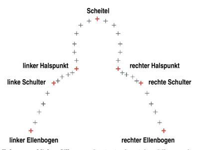
Bild 4.9: Modell der menschlichen Silhouette. Gezeigt ist die mittlere Silhouette des erzeugten PDM. Die rot eingezeichneten Punkte markieren die fixen Landmarken, d.h. die Punkte, die in jedem Trainingsbild korrespondieren müssen und die mit der Maus markiert werden. Die grauen Zwischenpunkte werden automatisch äquidistant platziert.
