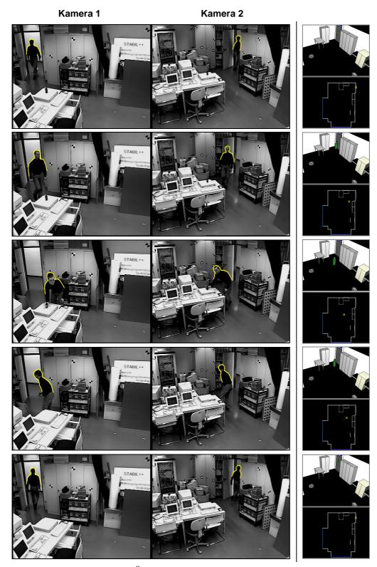
Bild 5.8: Stereodetektion. Links: Überwachung eines Raumes mit zwei Kameras. Die Person wird mit Hilfe des PDM-Modells für die menschliche Silhouette detektiert und über die Sequenz verfolgt. Die gefundene Silhouette ist gelb eingezeichnet. Rechts: 3D-Visualisierung der Umgebung in einem OpenGL-Monitor und Angabe der Position in einem 2D-Grundriss.
