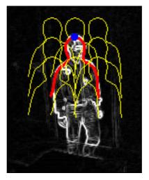
Bild 4.19: Vorsuche (presearch) bei einteiligen Konturen. Zur Ermittlung der optimalen Ausgangsposition für die PDM-Suche wird in der Umgebung der geschätzten Position für den Kopf (blauer Punkt) jeweils eine Iteration durchgeführt. Der Abstand der verschobenen Silhouetten (gelb) zur Ausgangssilhouette (rot) ist hier übertrieben groß dargestellt.
