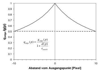
Bild 4.22: Berechnung der Punktqualität. Die Güte einer Kante ist umso größer, je höher der Grauwert  $g_{edge}(p)$  des betreffenden Pixels p im Kantenbild ist und je näher p am Ausgangspunkt liegt. Am Rand des Suchbereiches (im Beispiel:  $r_{search}=10$ ) erreicht die Punktqualität einen minimalen Wert von 0.5.
