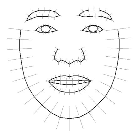
Bild 4.20: Suchintervall für die Kantensuche am Beispiel des Gesichtsmodells. Die Größe der Suchintervalle (grau) wird abhängig von der Größe des jeweiligen Konturteils gewählt (im Beispiel ist c=0,13).
