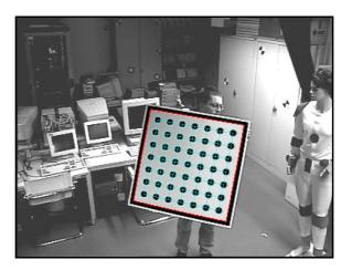
Bild 3.8: Kalibrierung der internen und externen Kameraparameter mit Hilfe einer exakt vermessenen zweidimensionalen Kalibrierplatte und mehreren Kalibriermarken, die im Hintergrund an den Schrankwänden zu sehen sind.
