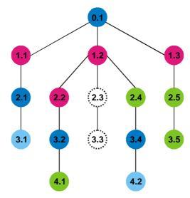
Bild 3.4: Innere Modellstruktur. Gezeigt ist der Baum für die Modellierung des menschlichen Skeletts mit 16 Objektmodellteilen (OMPs). Jedem OMP kann ein Merkmal zugeordnet werden. Im Beispiel erhält jedes OMP eine farbige Markierung als Merkmal. Die Farbe der Knoten entspricht den Farben der Markierungen. Den beiden schwarz gepunkteten Knoten, die Hals und Kopf repräsentieren, sind in diesem Beispiel kein Merkmal zugeordnet.
