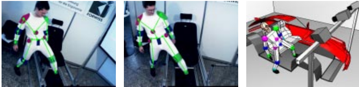
Abbildung 1.2: Anwendung zur Bewegungserfassung: Beobachtung eines Einstiegsvorgangs in einen PKW unter ergonomischen Gesichtspunkten. Hierzu werden die Gelenke der zu beobachtenden Person anhand farbiger Markierungen in mind. zwei Ansichten extrahiert, lokalisiert und die Gelenkwinkel bestimmt. Der erfaßte Bewegungsablauf läßt sich als animierte Computergraphik simulieren.
