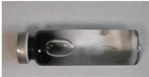
Bild 5.4: Nicht invasiver Partikeltransport in Flüssigkeiten. Die im Wasser schwebenden Eisenpartikel erscheinen in schwarzer Farbe.
