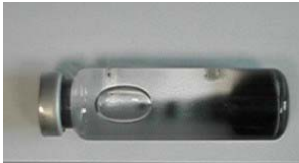
Bild 5.6: Nicht invasiver Partikeltransport in Flüssigkeiten. Der Großteil der schwebenden Eisenpartikel hat die rechte Seite der Flasche erreicht.
