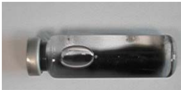
Bild 5.5: Nicht invasiver Partikeltransport in Flüssigkeiten (von links nach rechts). Die Transportgeschwindigkeiten sind hierbei stufenlos regelbar.
