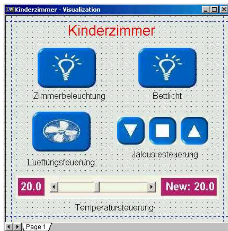
Bild 5.39. Die fertiggestellte Visualisierungs- und Steuerungsseite
