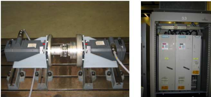
Abb. B.1: Maschinen mit mechanischer Kopplung (links) und den zugehörigen Umrichtern (rechts)
