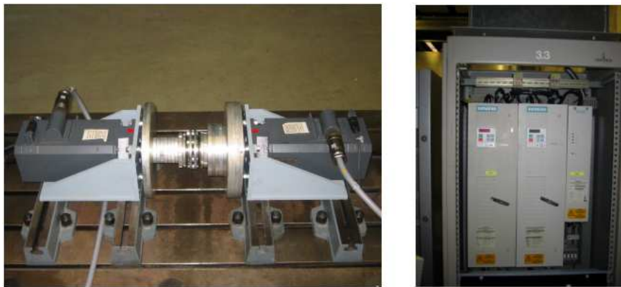
Abb. 8.2: Maschinen mit mechanischer Kopplung (links) und den zugehörigen Umrichtern (rechts)
