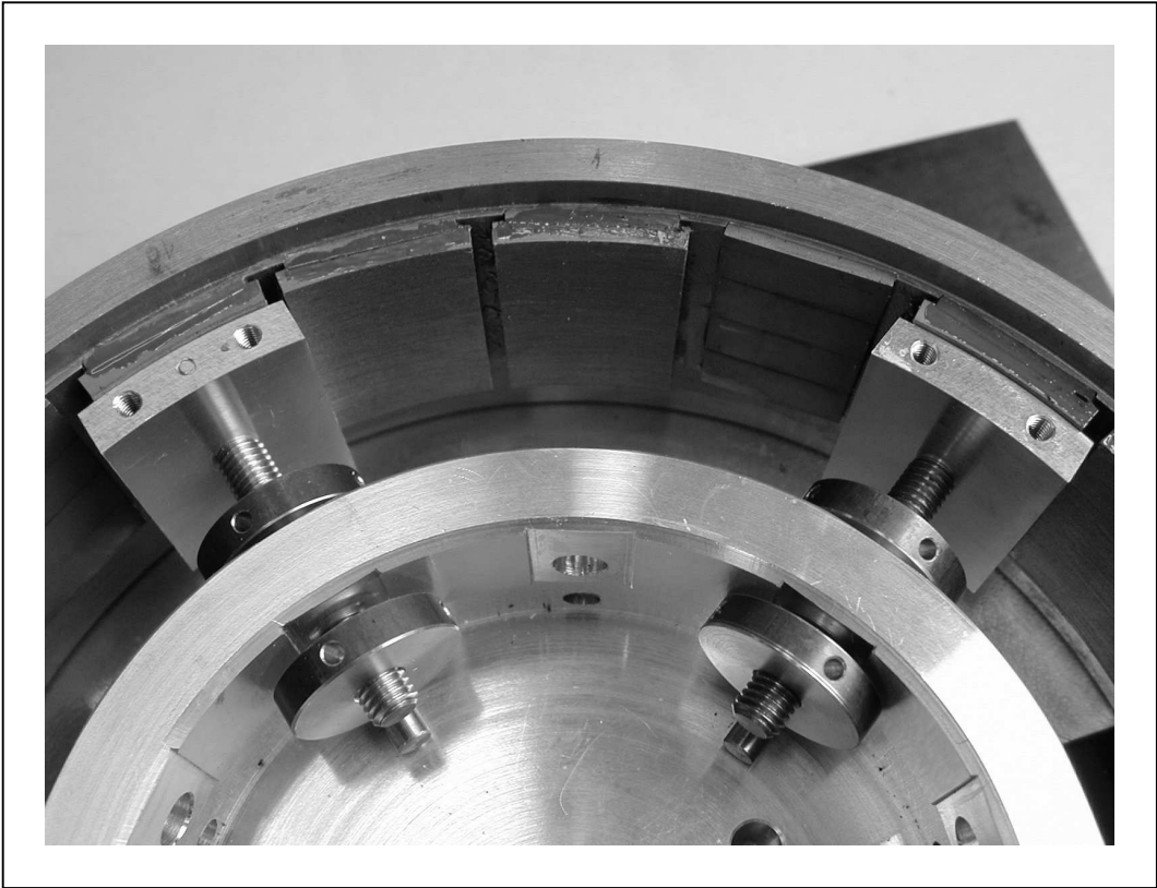
Abbildung 16: Hilfsvorrichtung für die Polschuhmontage
