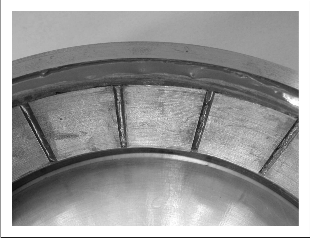
Abbildung 17: Fertig verklebter Rotor
