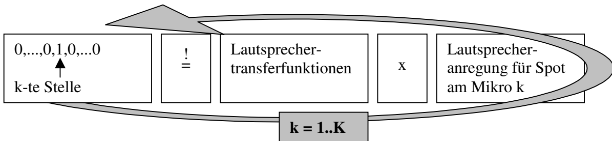
Abbildung 6.2-2 Schematischer Ablauf der Schallfeldsimulation zum Innengeräuschverfahren. (vgl. Text)
