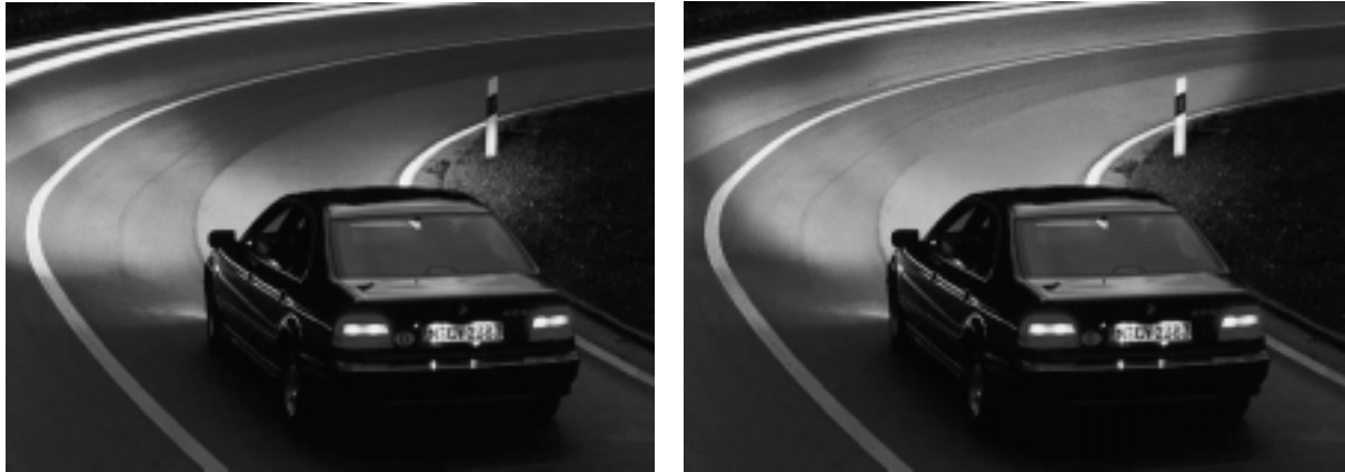
Abbildung 5-12: Vergleich der Ausleuchtung mit (links) und ohne (rechts) ALC
