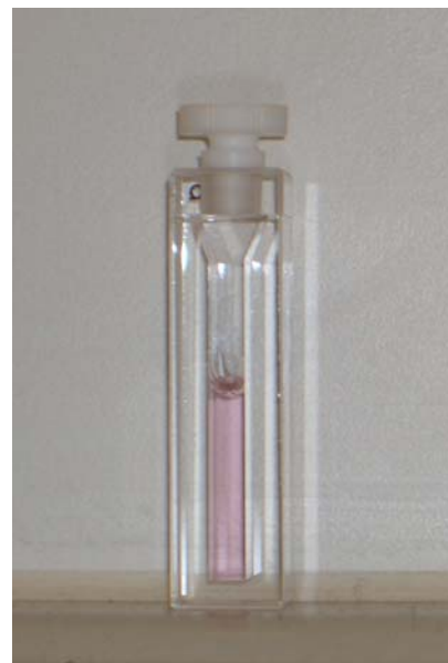
Abb.6-9: Temperaturabhängige Absorption des Duplexes F22/O22, 2.5 \mu\text{M} DNA in 10 mM \text{NaP}_i -Puffer. Die Absorption des Perylenbisimids ist mit bloßem Auge sichtbar.
