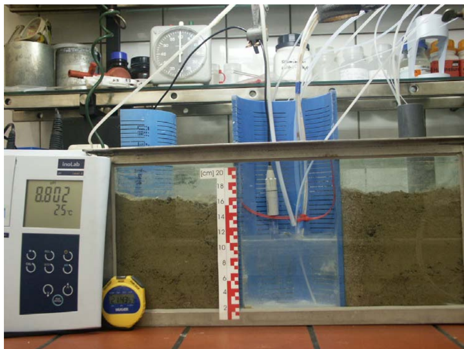
Abbildung A.12: Zeitliche Entwicklung der Versinterungen im Laborversuch: oben Leichte Verbesserung des Versinterungszustandes durch Lösung von Carbonaten (1413 h), unten Bestandsaufnahme bei Versuchsende (1468 h)
