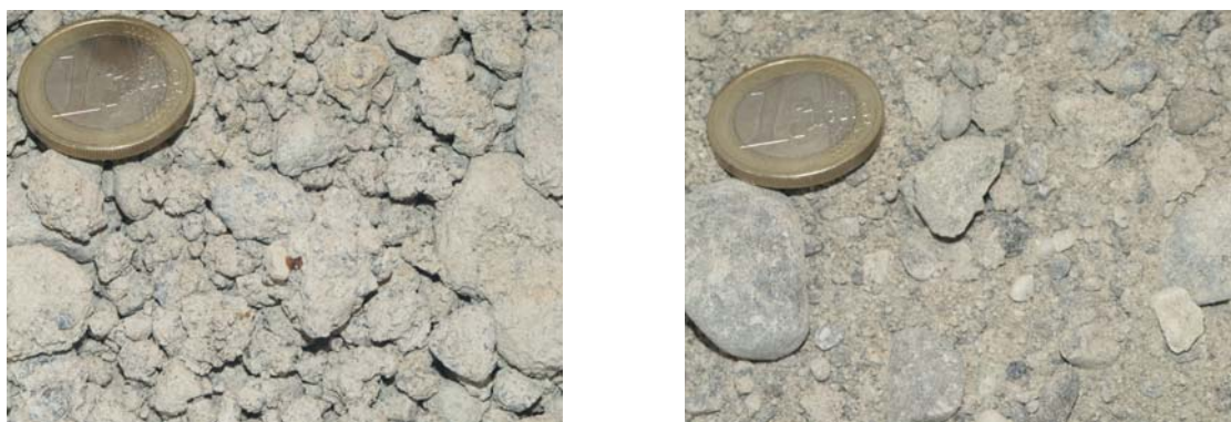
Abbildung 2.40: Vergleich des Bohrguts aus den Bohrungen HWS 42 Überbohrung (links) und HWS 41 (rechts)
