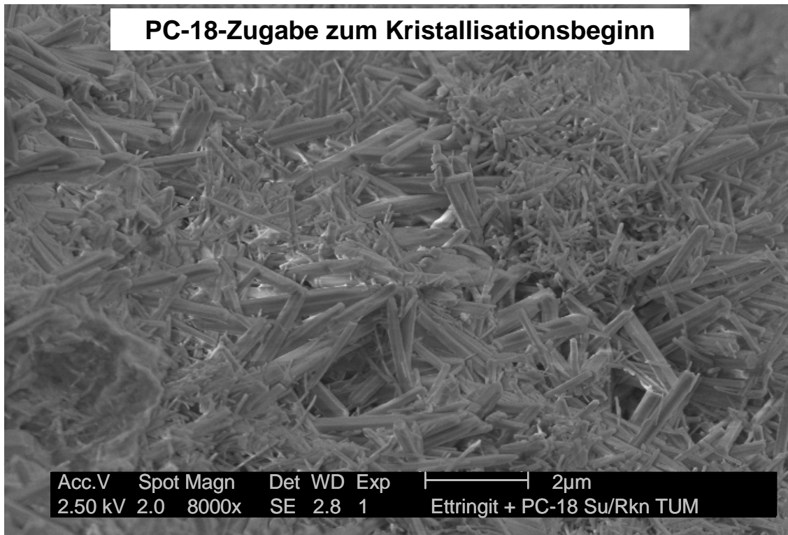
Abbildung 161: Ettringit, kristallisiert in Anwesenheit von PC-18 (ESEM-Aufnahme, 8000x)
