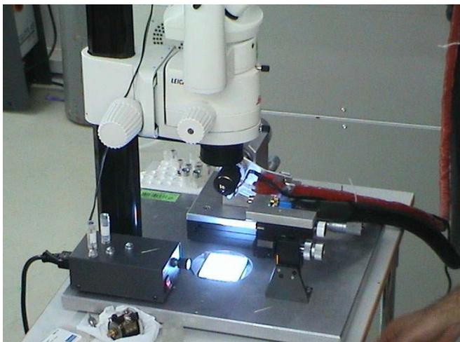
**Abbildung13: Montageplatz.** Der hier gezeigte Montageplatz umfasst im wesentlichen ein Videosystem (Mikroskop, Beleuchtung, CCD-Kamera) und einen drehbaren Goniometerkopfhalter zur Aufnahme des Probenkopfes. Der Goniometerkopfhalter ist auf einer Zweiachsenverschiebeeinheit montiert, um die Position der Probe relativ zur Optik anpassen zu können. Der Montageplatz dient als erstes zur Messung der Startfeuchte (optische Methode) und zur Montage des Kristalls in den Probenkopf.
