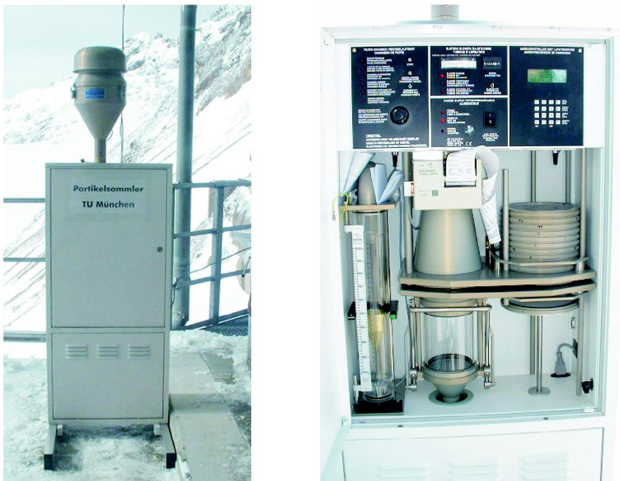
Abbildung 3.1: High-Volume-Sampler Digital DHA 80 auf der Zugspitze (links) mit Blick ins Innere (rechts).
