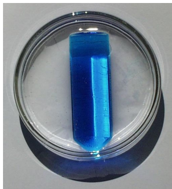
Abbildung 52: Gefärbter SGG-Monolith. Farbstoff: Methylenblau B.
