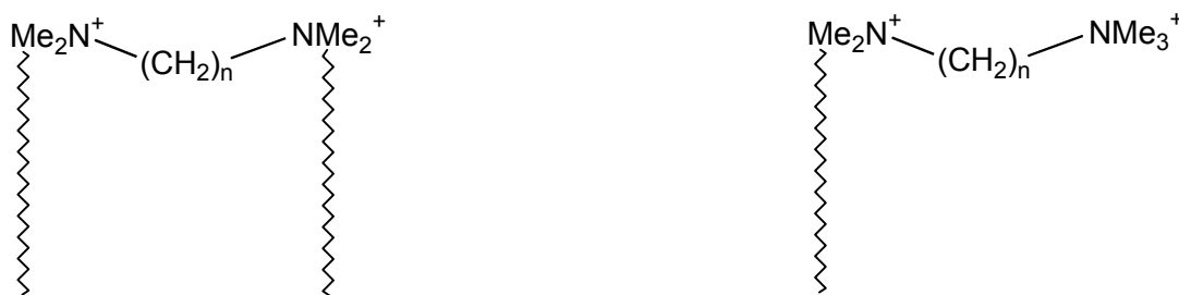
Abb. 3.2-5 Gemini- und divalente Tenside für die Synthesen von MCM-48-, SBA-2- oder MCM-41-Materialien.
