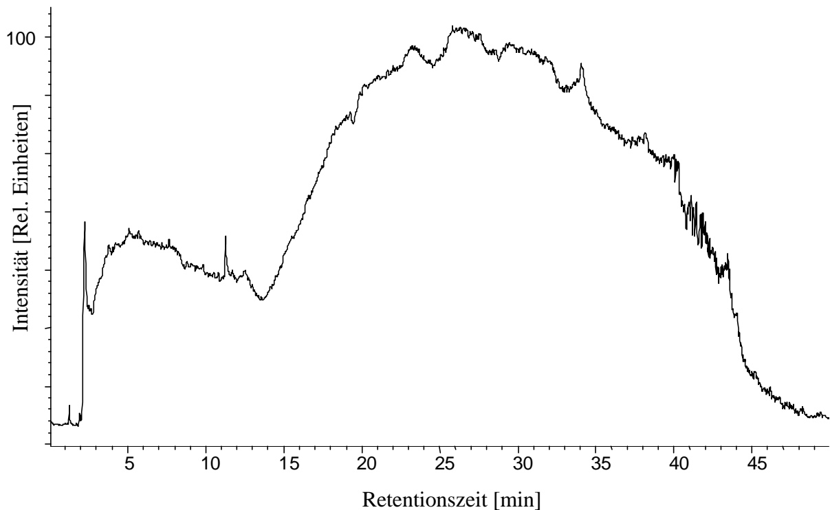
Abbildung 4-46: Total-Ionen-Chromatogramm der MeOH-Fraktion einer ruralen Winter-Aerosolprobe (APCI positiver Detektionsmodus, FV = 120\text{ V} , m/z\ 200 - 550 ).
