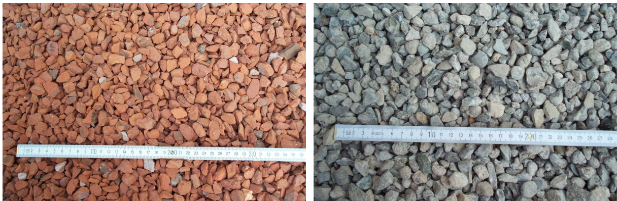
Bild 10 Beispiele für die gelieferten rezyklierten Körnungen (links: Ziegelsplitt 8/16; rechts: BetonSplitt 8/16)
