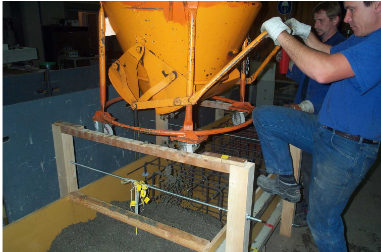
Bild 26 Betonage im Labor mit dem Betonkübel
