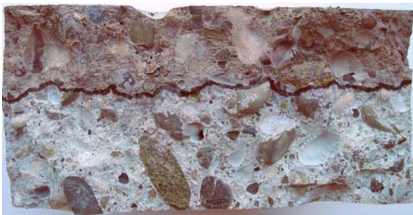
Bild 4-14: Gespaltene Betonprobe nach Migrationsversuch mit Jodid (Eintrag von Oberseite aus) und Aufsprüfung von Indikatorlösung. Eindringtiefe ist durch schwarze Linie gekennzeichnet
