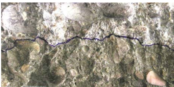
Bild 4-3: Im RCM-Versuch von Bildunterkante aus eingedrungene Chloridfront
