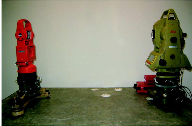
Abbildung 5.7: Messaufbau zur Prüfung der Querneigungsänderung beim GAP1
