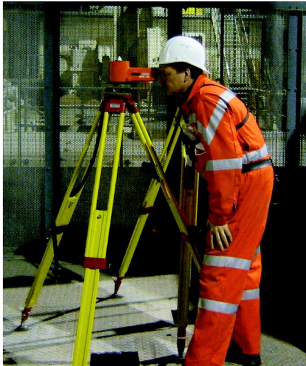
Abbildung 7.2: Nadirlot am Schachtkopf [Ryf]
