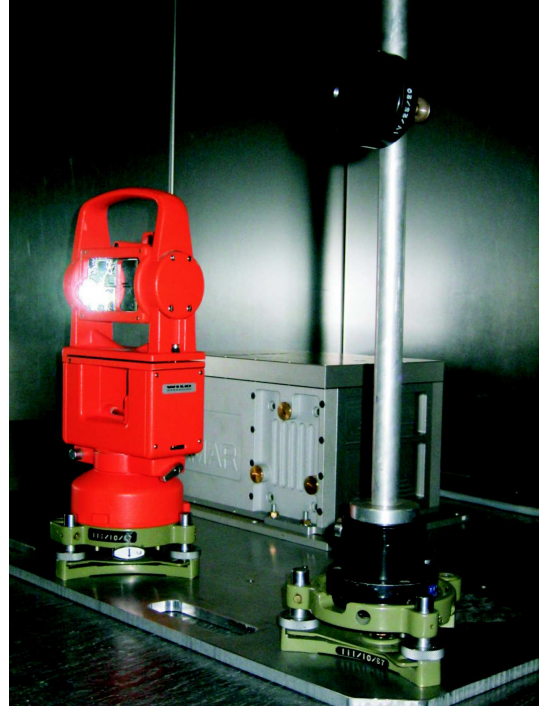
Abbildung 6.23: Messungen im Lift des Olympiaturms, Montageplatte
