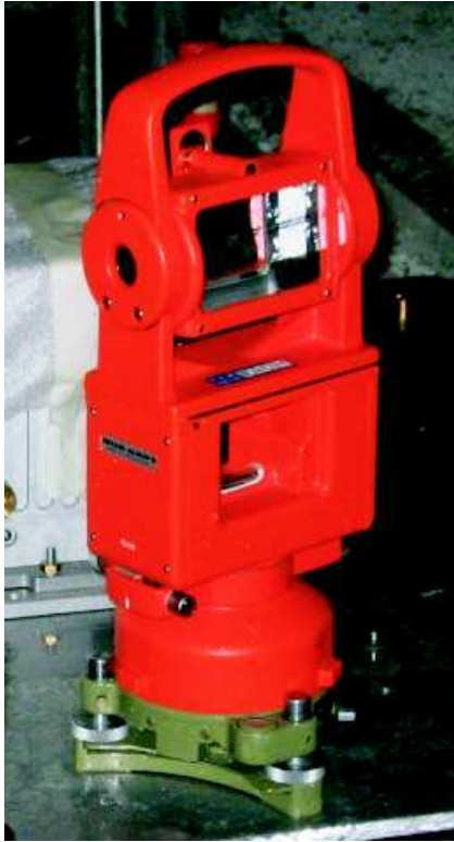
Abbildung 5.5: Autokollimationsprisma von Wild Heerbrugg [WILD HEERBRUGG]
