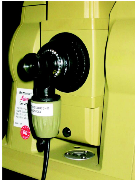
Abbildung 5.2: Autokollimationsokular von Leica Geosystems
