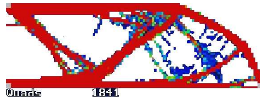
Abbildung 4.11: Kragarm nach 40. Iteration
