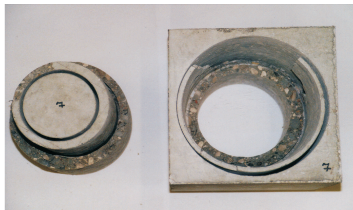
Abbildung 10.8: Versuchsaufbau, intakter Probekörper und abgedrückter Probekörper
