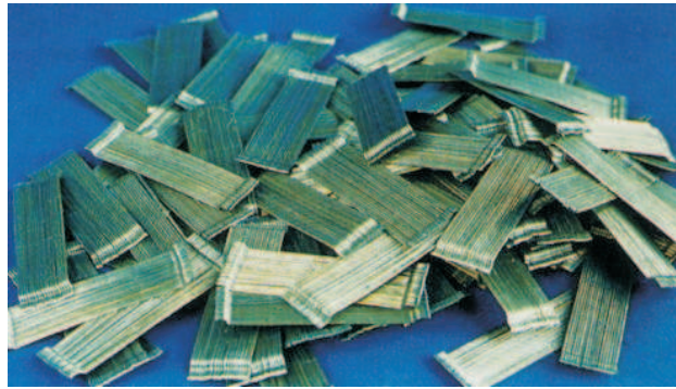
Abbildung 2.2: Zu Streifen verklebte Drahtfasern mit Endaufbiegung
