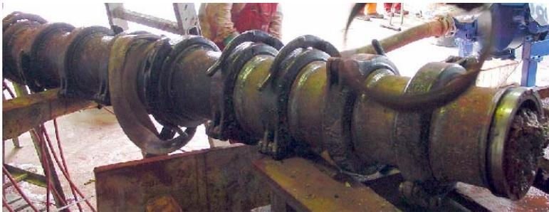
Abb.10-14 Modifizierter Fingermischer (Bild)
