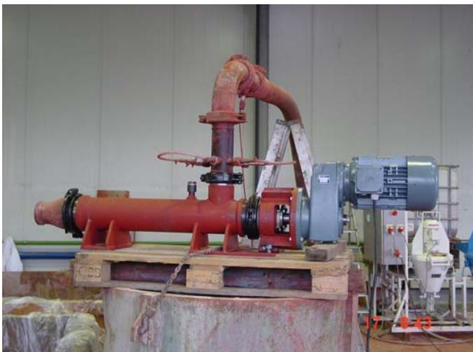
*Abb.10-17: Aktiver Inline-Mischer (Bild)*
