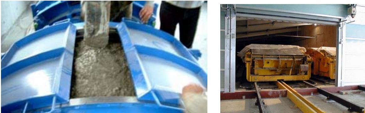
*Abb.2-4: Betoniervorgang, Einfahren der Schalung in die Klimakammer*
