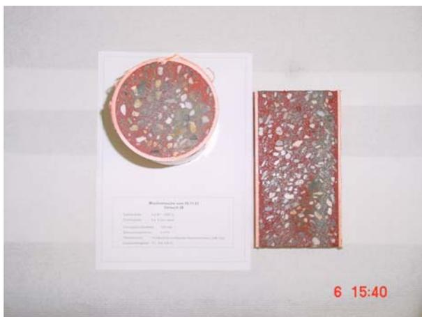
Abb.10-12 Ergebnis Farbversuch mit modifiziertem Kenicsmischer (10 Mischerelemente) und einer Injektoreinheit 90°
