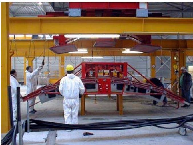
*Abb.2-5: Aufkleben der Tübbingfugendichtung*
