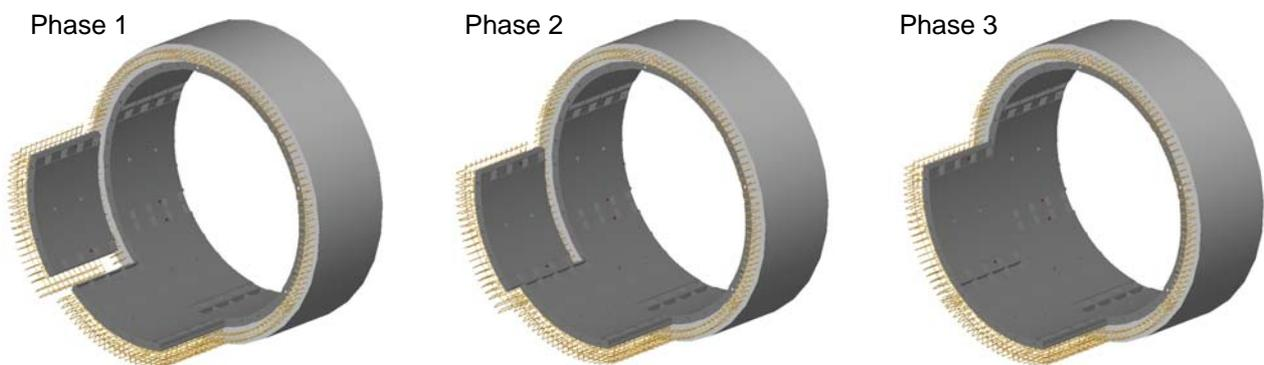
*Abb.4-37: Phasenweises Versetzen des zweiten Normal-Schalungselementes*
