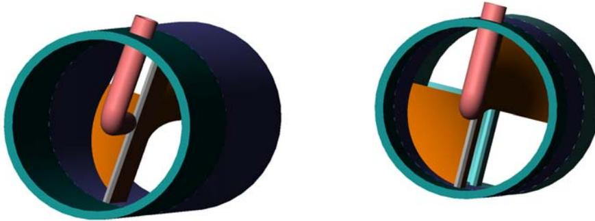
Abb.10-10 Modifizierter Kenicsmischer mit Injektoreinheit mit zwei Mischereinheiten
