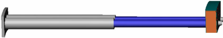
*Abb.5-8: Vortriebspresse im ausgefahrenen Zustand mit Pressenschuh und Dichtung*
