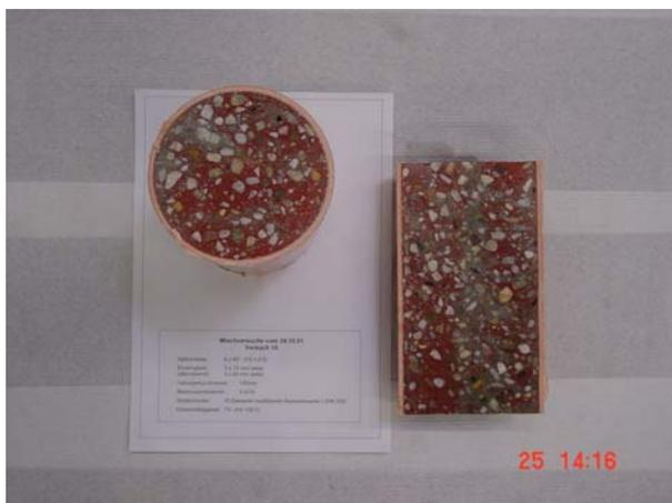
Abb.10-11 Ergebnis Farbversuch mit modifiziertem Kenicsmischer (10 Mischerelemente) und einer Injektoreinheit 40° in Strömungsrichtung
