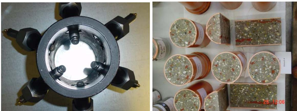
Abb.10-9: Düsenanordnung 40° in Strömungsrichtung, Eindringtiefe: 3x25mm, 3x15mm
