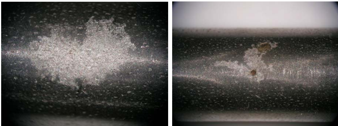
Bild A2: Aufnahmen von gebeizten Korrosionsstellen, links: Probe a, rechts: Probe b; Versuchsparameter s. Bild A1
