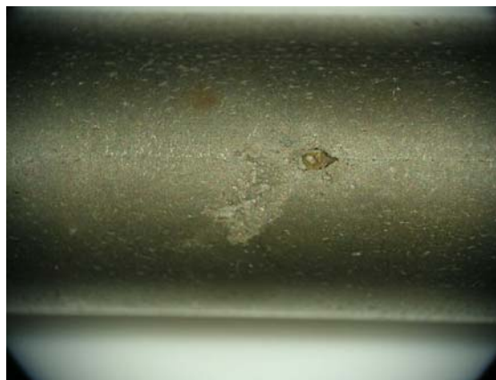
Bild A12: Aufnahmen einer gebeizten Korrosionsstelle, Probe b; Versuchsparameter s. Bild A11
