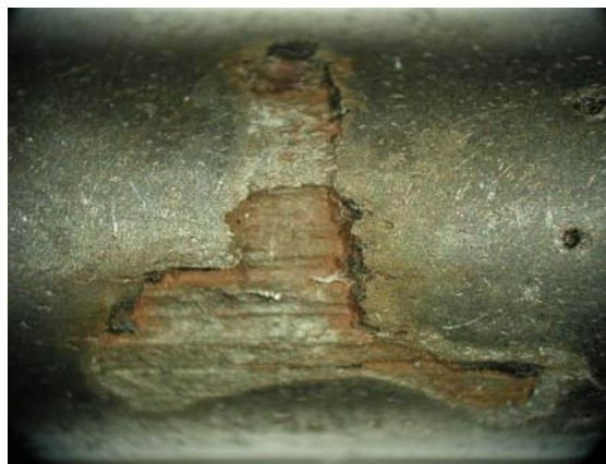
Bild A10: Aufnahmen einer gebeizten Korrosionsstelle; Versuchsparameter s. Bild A9
