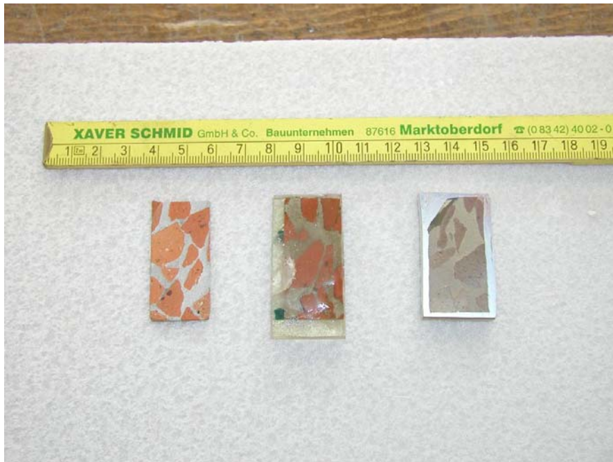
Bild 5: Proben für die Untersuchung im REM; links: nach dem Sägen, in der Mitte: nach dem Aushärten des Harzes, rechts: nach dem bedampfen mit Kohlenstoff
