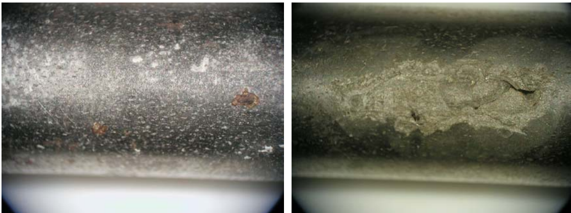
Bild A4: Aufnahmen von geätzten Korrosionsstellen, links: Probe a, rechts: Probe b; Versuchsparameter s. Bild A3
