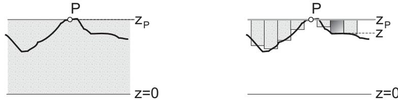
Abbildung 4.21: Alternative Modellierung der Gesamtopographie durch Bouguerplatte (links) und Geländekorrekturen (rechts).
