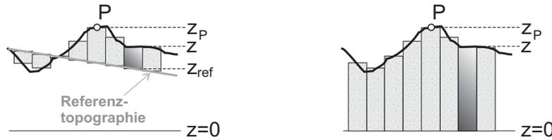
Abbildung 4.20: Modellierung der RTM-Topographie (links) und der gesamten Topographie (rechts) mit Prismen.
