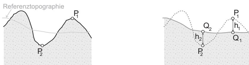
Abbildung 4.22: Gelände vor und nach Reduktion der RTM-Topographie. Die Punkte  $P_1$  und  $P_2$  der realen Topographie repräsentieren nach der Reduktion Schwerestationen, die in „freier Luft schweben“ ( $P_1$ ) bzw. in den Massen „vergraben“ sind ( $P_2$ ).
