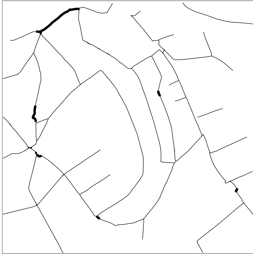
Abbildung 6.15. Differenz zwischen vorläufiger Extraktion und vervollständigter Extraktion (dünne Linien: vorläufige Extraktion, breite Linien: im Rahmen der Vervollständigung eingefügte Verbindungen)
