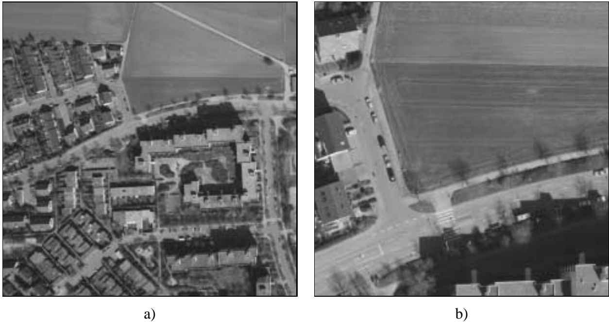
Abbildung 2.2. Beispiele für verschiedene Auflösungen: a) Niedrige Auflösung (3 m), b) Hohe Auflösung (0.2 m), Ausschnitt aus a)
