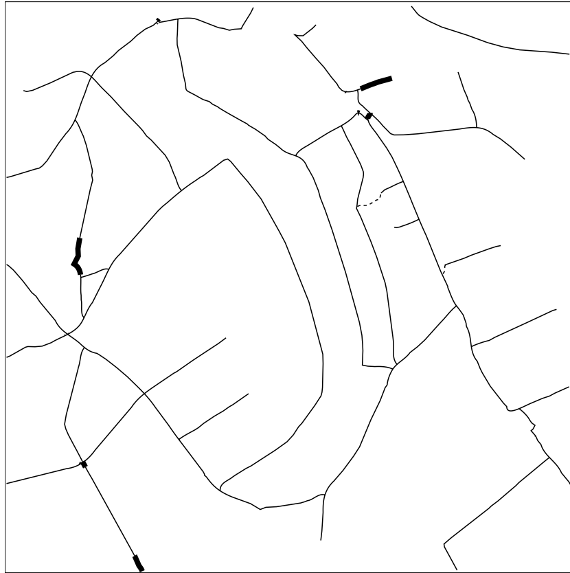
Abbildung 6.29. Differenz zwischen den Ergebnissen bei Anwendung der globalen und einer lokalen Gruppierung (dünne Linien: Ergebnisse stimmen überein, breite Linien: Bei lokaler Gruppierung nicht extrahierte Teile, gestrichelte Linien: Bei lokaler Gruppierung zusätzlich extrahierte Teile)
