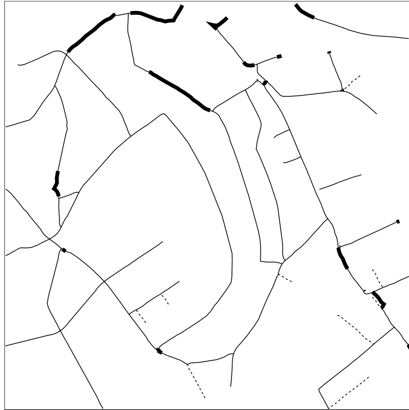
Abbildung 6.27. Differenz zwischen den Ergebnissen bei Verwendung der drei spektralen Kanäle und bei Verwendung des panchromatischen Kanals (dünne Linien: Ergebnisse stimmen überein, breite Linien: Bei Verwendung des panchromatischen Kanals nicht extrahierte Teile, gestrichelte Linien: Bei Verwendung des panchromatischen Kanals zusätzlich extrahierte Teile)
