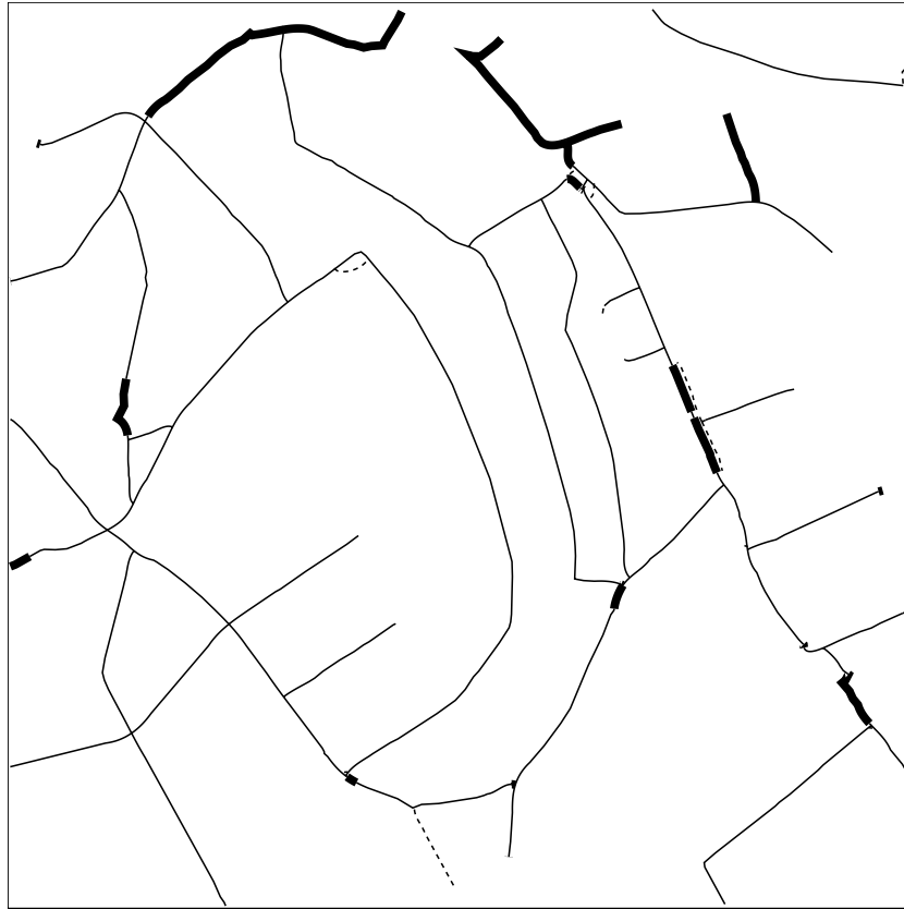
Abbildung 6.31. Differenz zwischen den Ergebnissen bei Anwendung von Fuzzy-Membership-Funktionen und von harten Schwellwerten (dünne Linien: Ergebnisse stimmen überein, breite Linien: Bei Anwendung harter Schwellwerte nicht extrahierte Teile, gestrichelte Linien: Bei Anwendung harter Schwellwerte zusätzlich extrahierte Teile)
