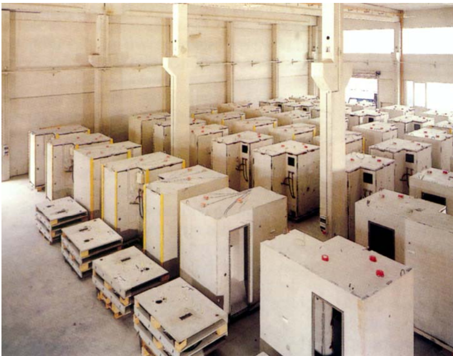
Bild 405 oberflächen- und anschlussfertige Raumzellen aus Beton
