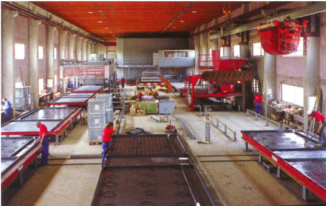
Bild 327 Fertigungsstraße für die Liegendelementfertigung
