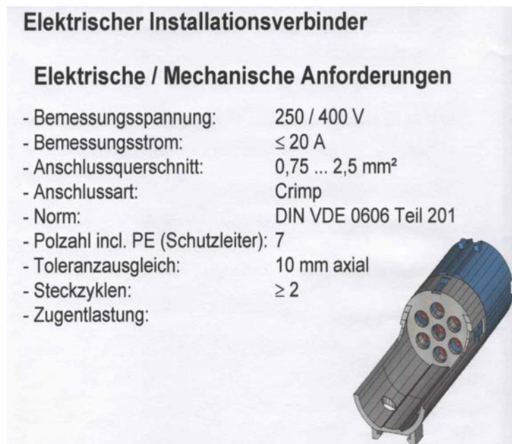
Bild 395 Entwicklungsstand Elektrostecker nach Einarbeitung der VDE Vorgaben
