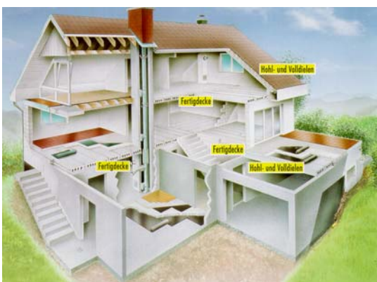
Bild 71 Übersicht zum Einsatz von Fertigteilen
