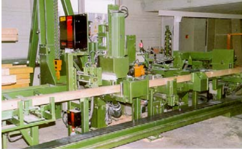
Bild 146 Schwellen- und Pfettenstation
