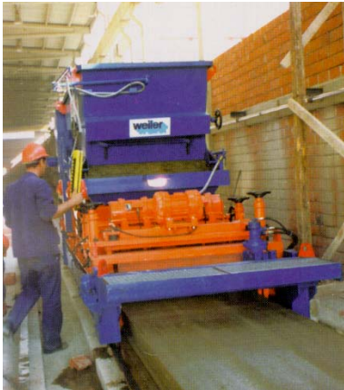
Bild 51 Modulgleitfertiger der Fa. Weiler
