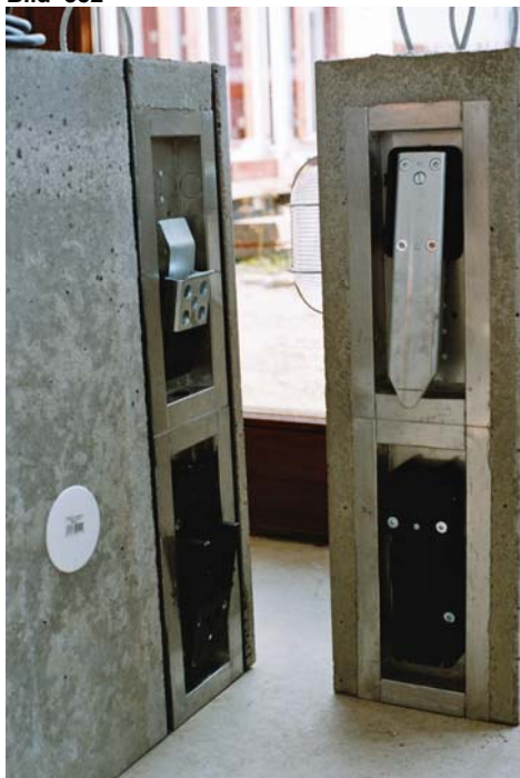
Bild 354 Betonmodelle nach dem Ausschalen, oben rechts: Schwerlastverschraubung und Leerrohreinleitung
