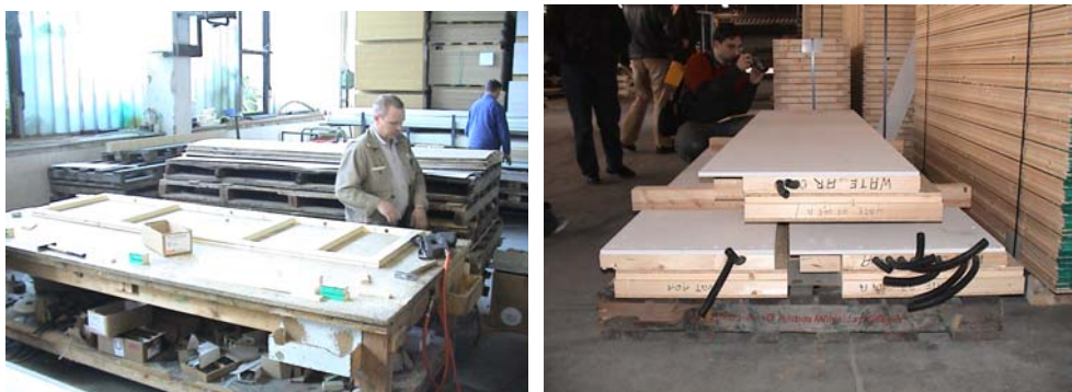
Bild 142-143 Paneelelemente bei der Vorbereitung zur Befüllung mit PU-Schaum, Fa. Purholz
