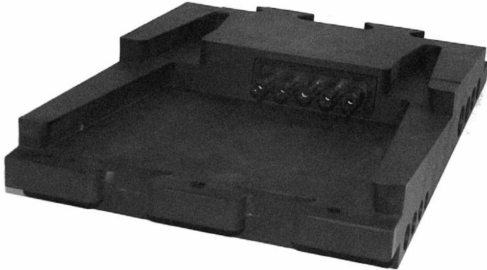
Bild 194 erstes Modell einer Schnellverbinderhälfte mit eingesetztem Serienstecker der Fa. Wieland Electric aus Bamberg, hier Basissteckerteil mit 5-poligem Elektrostecker
