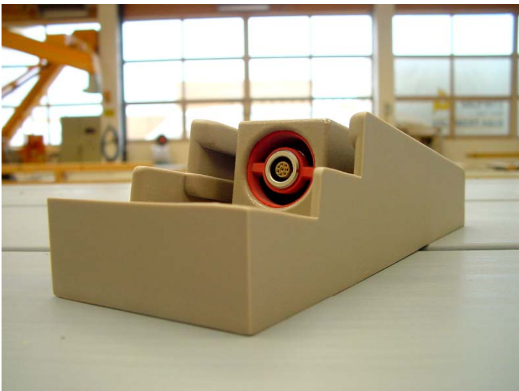
Bild 208 Datenstecker im Prototypengehäuse
