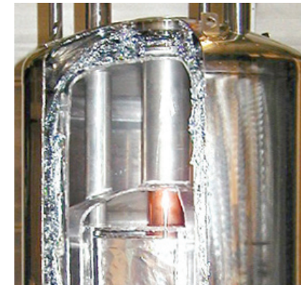
Abb. 2.20 Aufgeschnittenes Gefäß für den Betrieb eines supraleitenden Magneten bei ca. 4 K Umgebungstemperatur. 36
