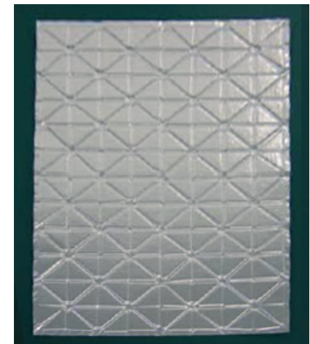
Abb. 5.59 ‚Chip-Vacua‘ mit dreieckiger Grundgeometrie
