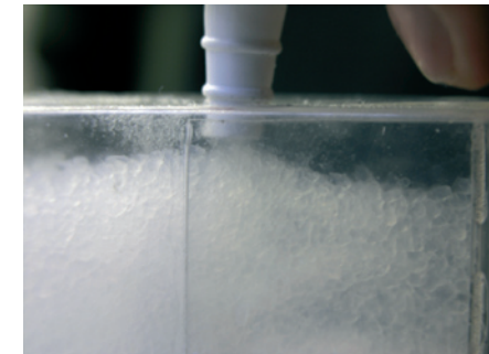
Abb. 7.55 Füllung der einzelnen Lamellenkammern mit Aerogelgranulat der Firma Cabot.
