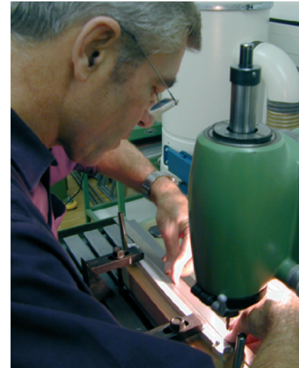
Abb. 7.31 Manuelle Fertigung der Rippen und anderer Aluminiumteile aus Standardteilen (Flach-, Rund- und Winkelprofile)
