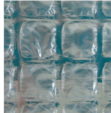
Abb. 5.3 Luftpolsterfolie 1 aus HDPE, Viereck-Geometrie, Stegbreite 2 mm, Zellhöhe 3-4 mm
