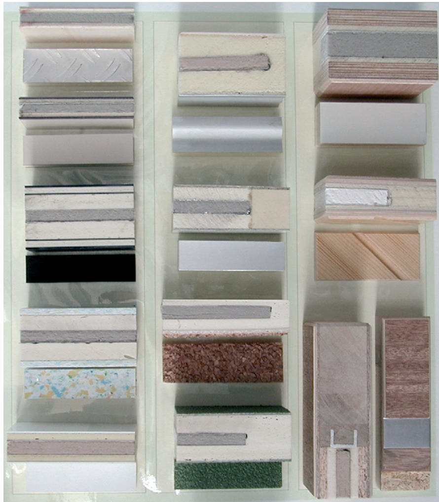
Abb. 4.6 Diverse Sandwichkonstruktionen mit verschiedenen Schalen- und Verschleißschichtmaterialien in Schnitt- und Ansichtsmustern der Firma VarioTec, wie sie für den Baubereich und diverse andere Anwendungsgebiete (z.B. die Transportbranche) gedacht sind. 12
