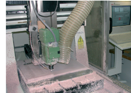
Abb. 7.48 Herstellung der Formen für die Vakuumumformung auf der CNC-Fräse des TZ
