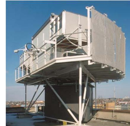
Abb. 7.02 Meßeinrichtungen (Meßboxen) auf Stahlgerüst als flexibel nutzbarer Plattform
